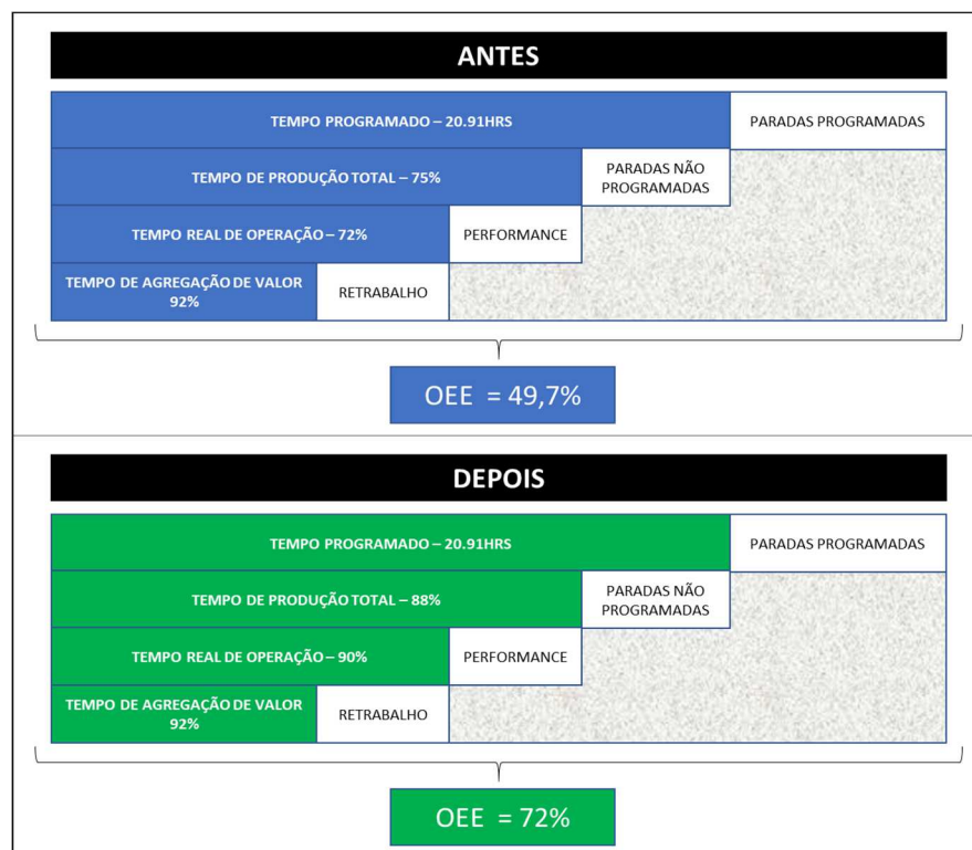
Figura 9 - Comparação OEE antes e depois da implantação
