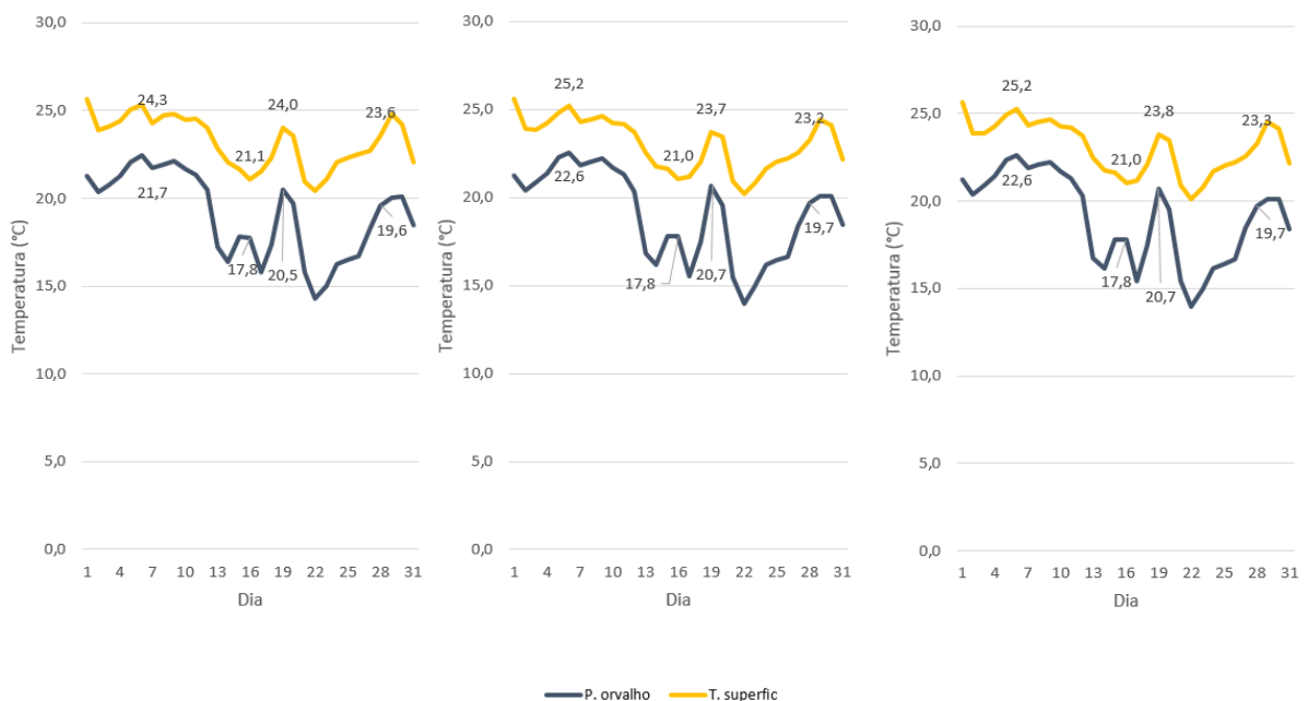
Figura 34: Temperatura das superfícies e do ponto de condensação na Z3 no mês de MARÇO, MV de BV: (a) 5 ren/h, (b) 10 ren/h e (c) 12 ren/h
