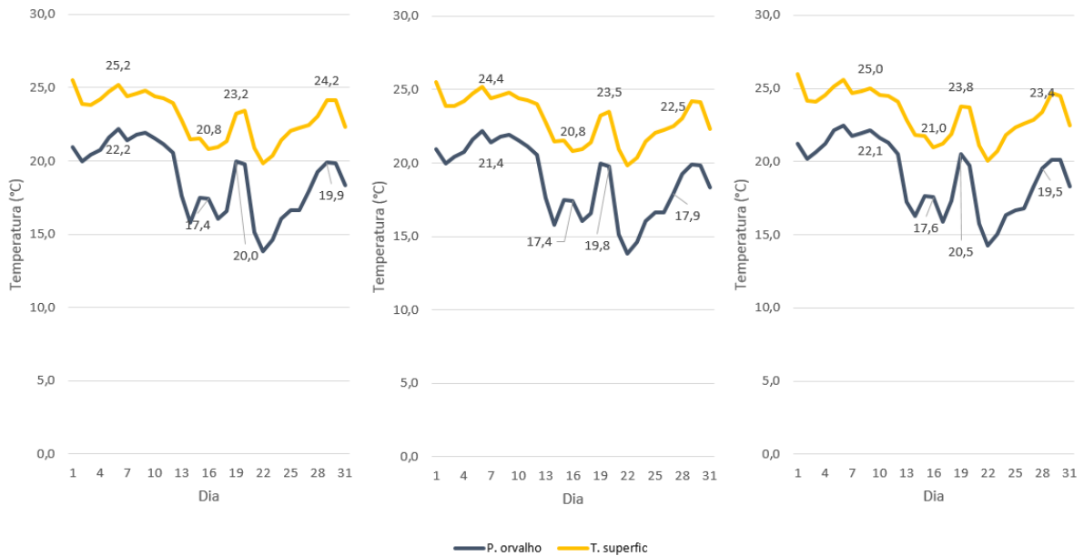
Figura 24: Temperatura das superfícies e do ponto de condensação na Z2 no mês de MARÇO, MH de BV: (a) 5 ren/h, (b) 10 ren/h e (c) 12 ren/h
