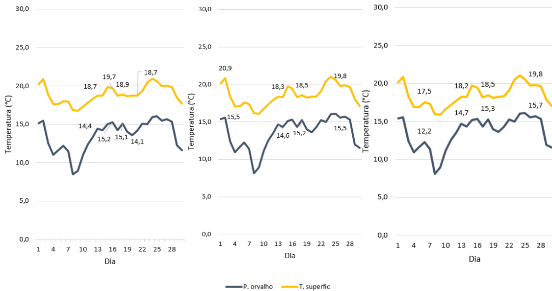
Figura 46: Temperatura das superfícies e do ponto de condensação na Z3 no mês de JUNHO, MH de SL: (a) 5 ren/h, (b) 10 ren/h e (c) 12 ren/h.
