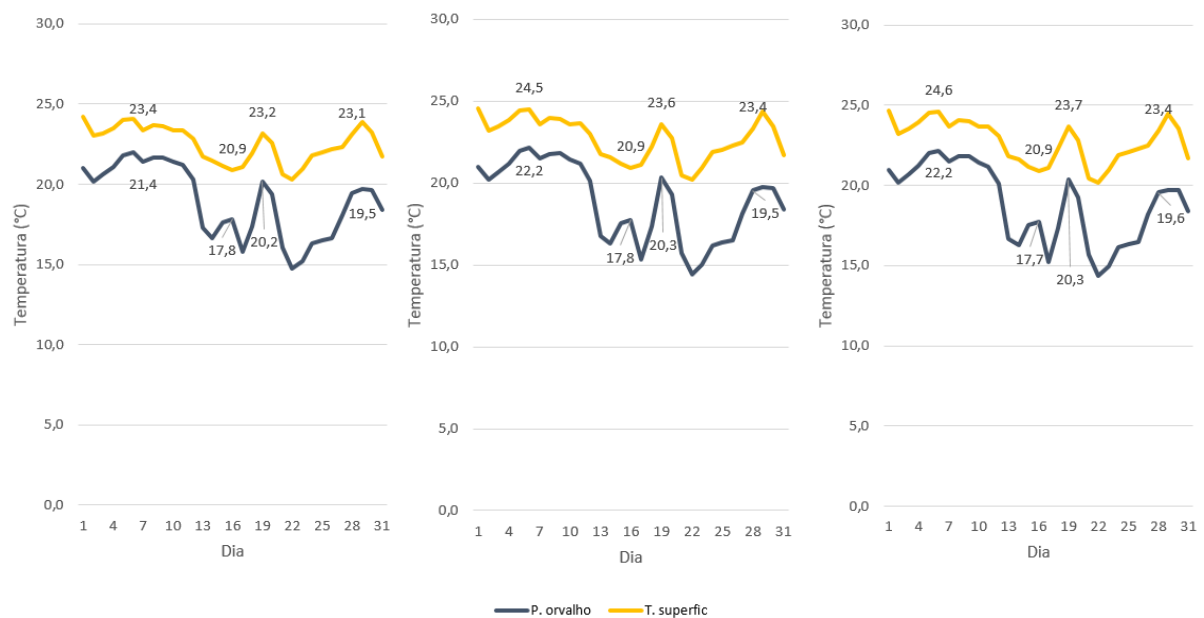
Figura 28: Temperatura das superfícies e do ponto de condensação na Z3 no mês de MARÇO, MH de SL: (a) 5 ren/h, (b) 10 ren/h e (c) 12 ren/h
