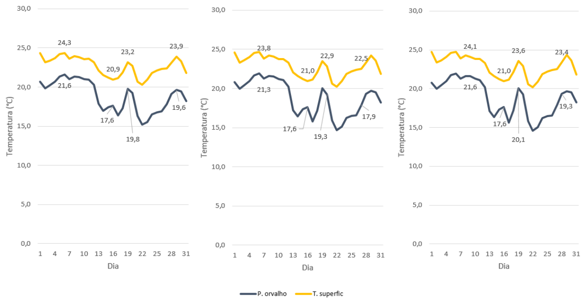
Figura 27: Temperatura das superfícies e do ponto de condensação na Z2 no mês de MARÇO, MH de SL: (a) 5 ren/h, (b) 10 ren/h e (c) 12 ren/h
