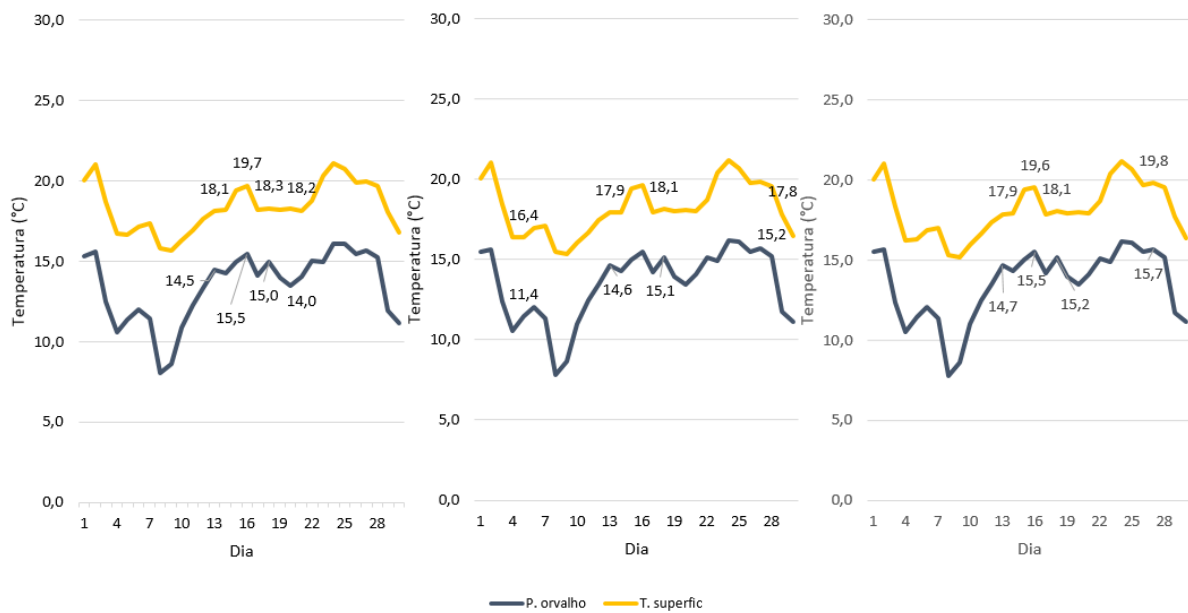
Figura 49: Temperatura das superfícies e do ponto de condensação na Z3 no mês de JUNHO, MV de CM: (a) 5 ren/h, (b) 10 ren/h e (c) 12 ren/h.
