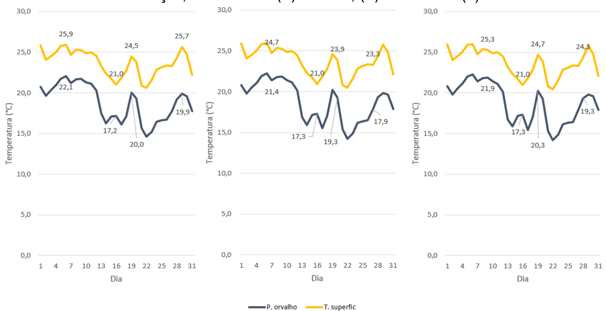
Figura 30: Temperatura das superfícies e do ponto de condensação na Z2 no mês de MARÇO, MV de CM: (a) 5 ren/h, (b) 10 ren/h e (c) 12 ren/h
