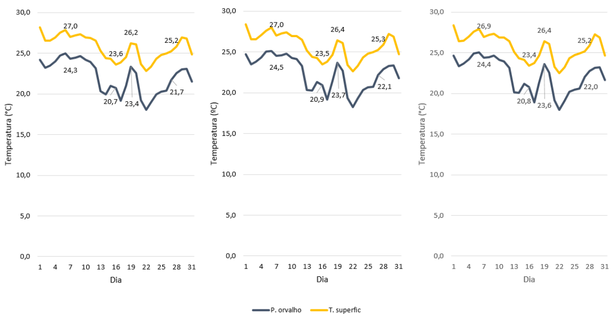
Figura 32: Temperatura das superfícies e do ponto de condensação na Z1 no mês de MARÇO, MV de BV: (a) 5 ren/h, (b) 10 ren/h e (c) 12 ren/h
