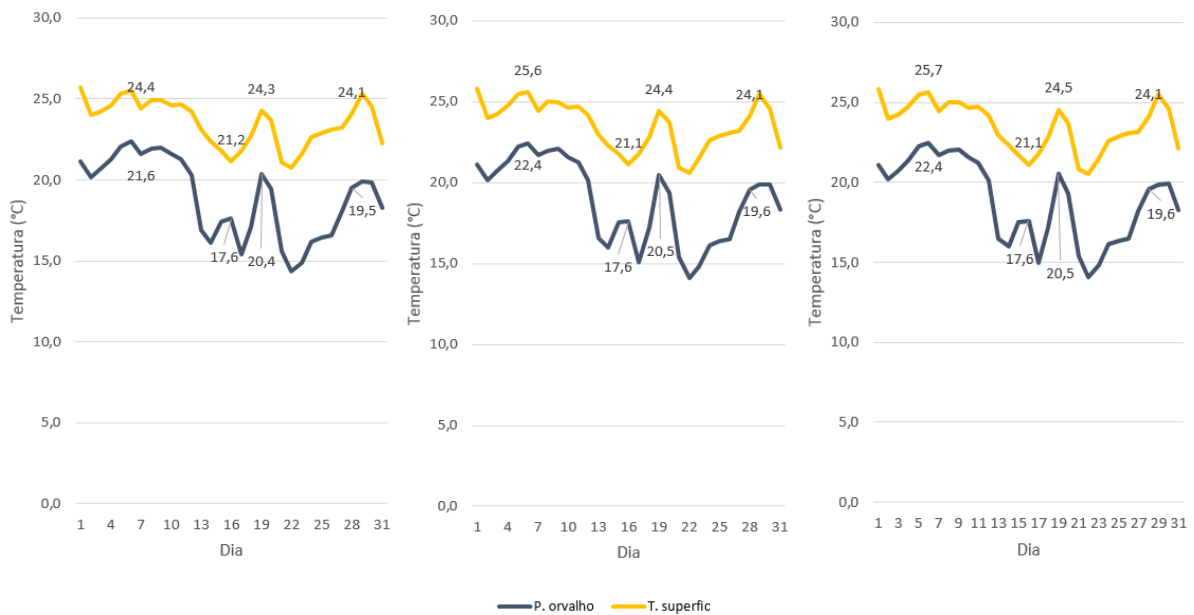
Figura 22: Temperatura das superfícies e do ponto de condensação na Z3 no mês de MARÇO, MH de CM: (a) 5 ren/h, (b) 10 ren/h e (c) 12 ren/h
