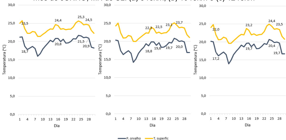
Figura 44: Temperatura das superfícies e do ponto de condensação na Z1 no mês de JUNHO, MH de SL: (a) 5 ren/h, (b) 10 ren/h e (c) 12 ren/h
