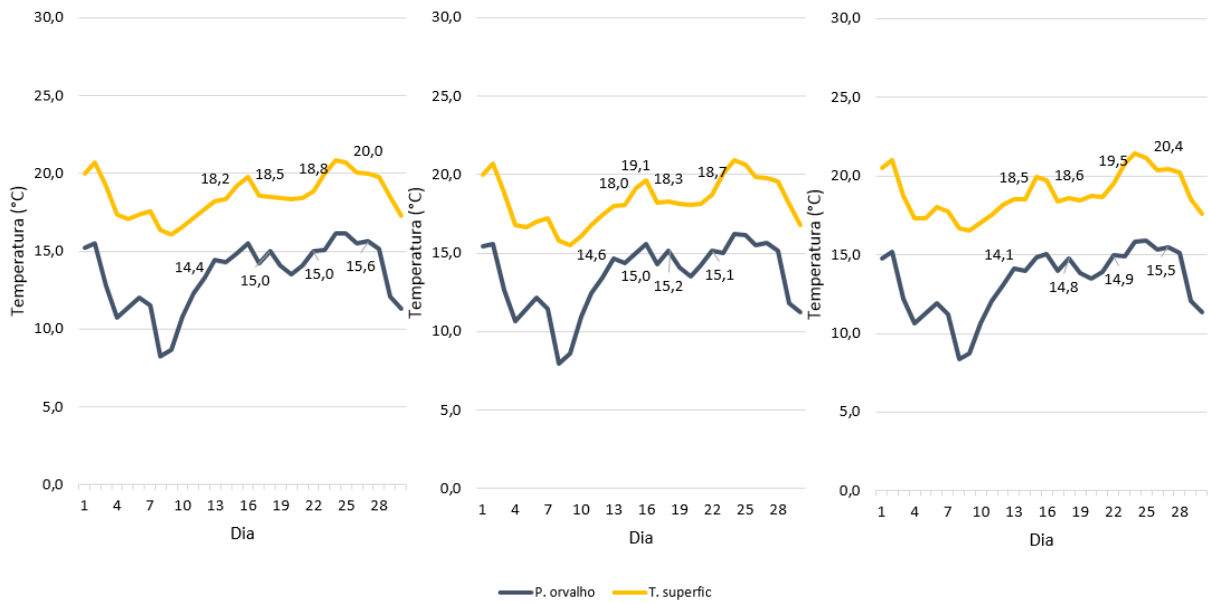
Figura 54: Temperatura das superfícies e do ponto de condensação na Z2 no mês de JUNHO, MV de SL: (a) 5 ren/h, (b) 10 ren/h e (c) 12 ren/h.
