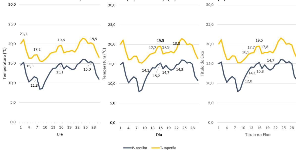
Figura 48: Temperatura das superfícies e do ponto de condensação na Z2 no mês de JUNHO, MV de CM: (a) 5 ren/h, (b) 10 ren/h e (c) 12 ren/h.
