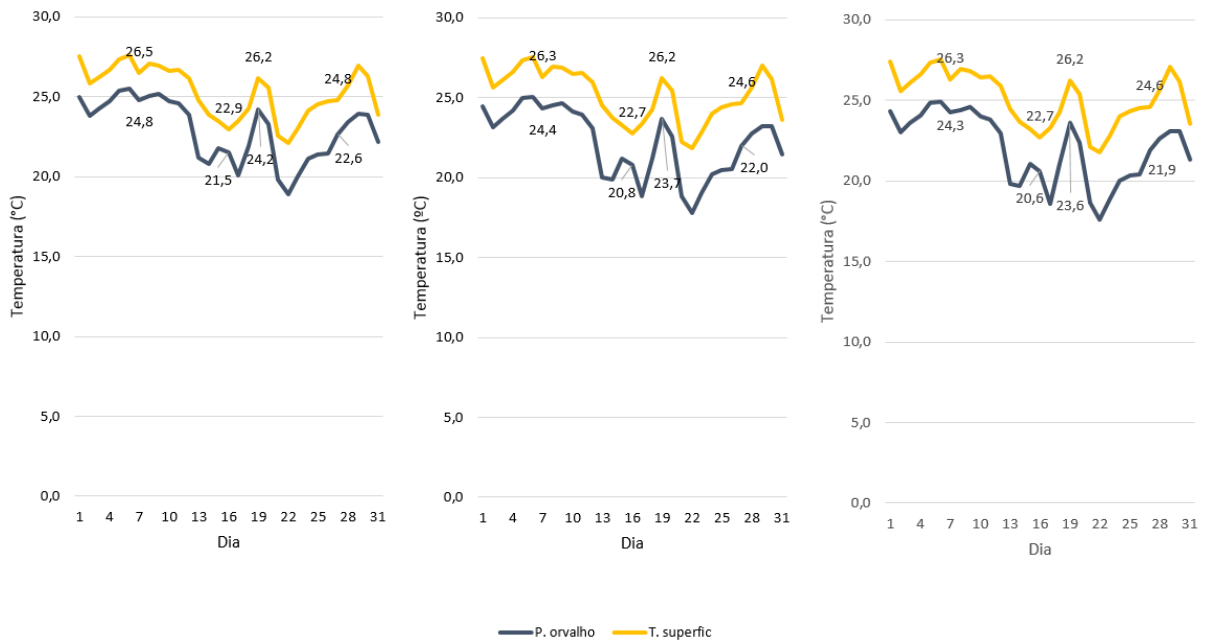
Figura 29: Temperatura das superfícies e do ponto de condensação na Z1 no mês de MARÇO, MV de CM: (a) 5 ren/h, (b) 10 ren/h e (c) 12 ren/h
