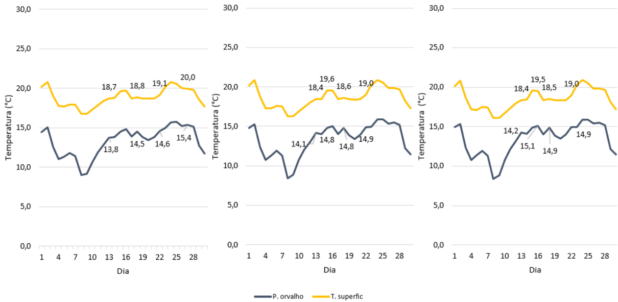
Figura 45: Temperatura das superfícies e do ponto de condensação na Z2 no mês de JUNHO, MH de SL: (a) 5 ren/h, (b) 10 ren/h e (c) 12 ren/h
