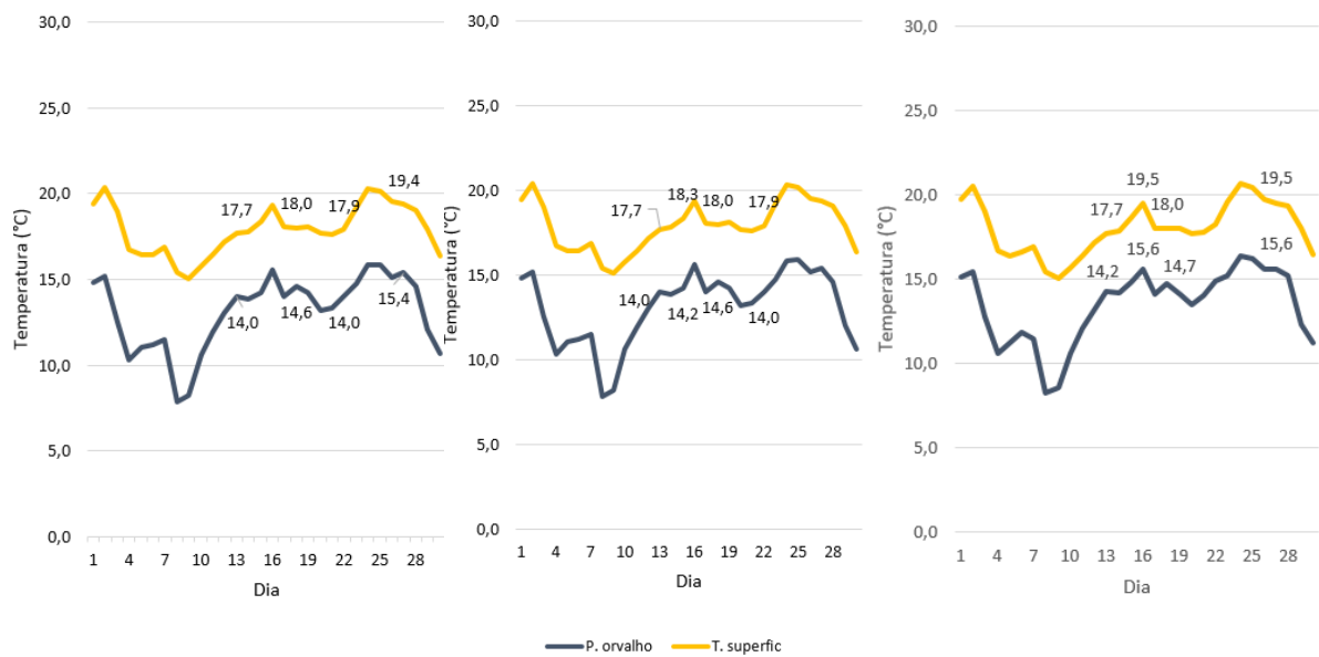
Figura 42: Temperatura das superfícies e do ponto de condensação na Z2 no mês de JUNHO, MH de BV: (a) 5 ren/h, (b) 10 ren/h e (c) 12 ren/h
