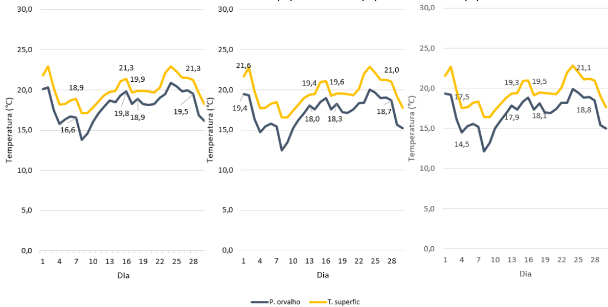
Figura 47: Temperatura das superfícies e do ponto de condensação na Z1 no mês de JUNHO, MV de CM: (a) 5 ren/h, (b) 10 ren/h e (c) 12 ren/h.
