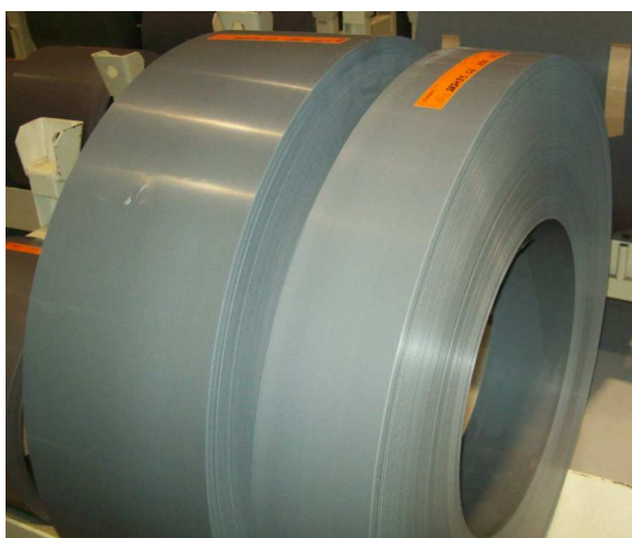
Figura 5 - Bobina cortada em larguras menores (fitas)
