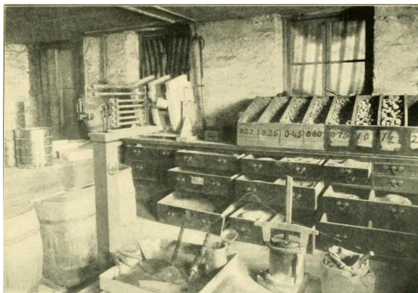
Figura 15 - Equipamentos e agregados utilizados por Fuller e Thompson em 1907
