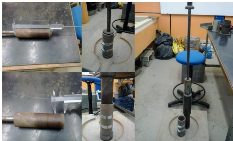
Figura 39 – Compactador utilizado nas moldagens.
