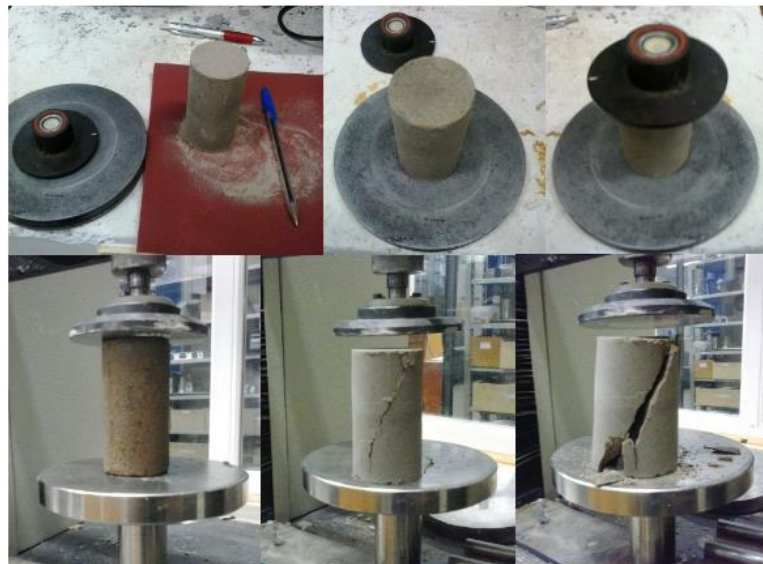
Figura 43 - Ajuste do topo dos corpos de prova e ensaio de compressão axial
