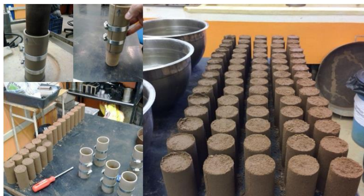
Figura 40 – Moldagem, desmoldagem e corpos de prova finalizados
