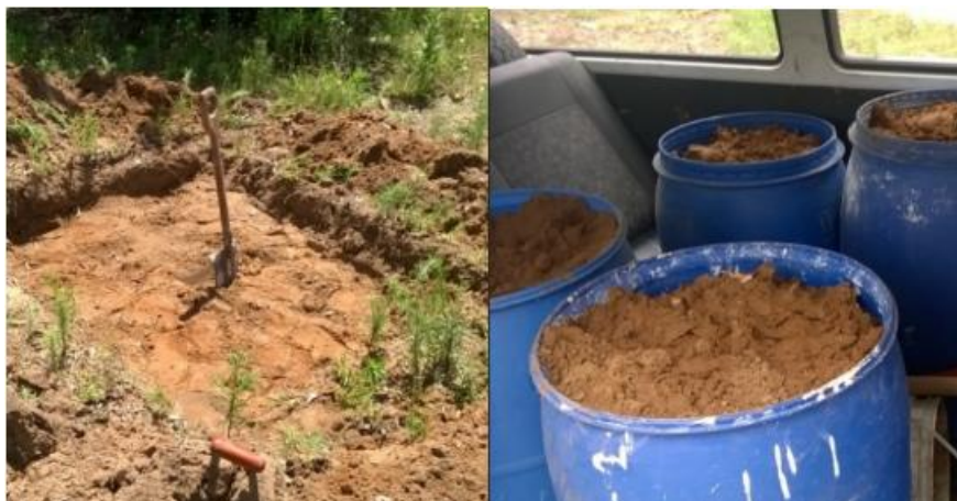
Figura 27- Escavação e acondicionamento da amostra de solo.
