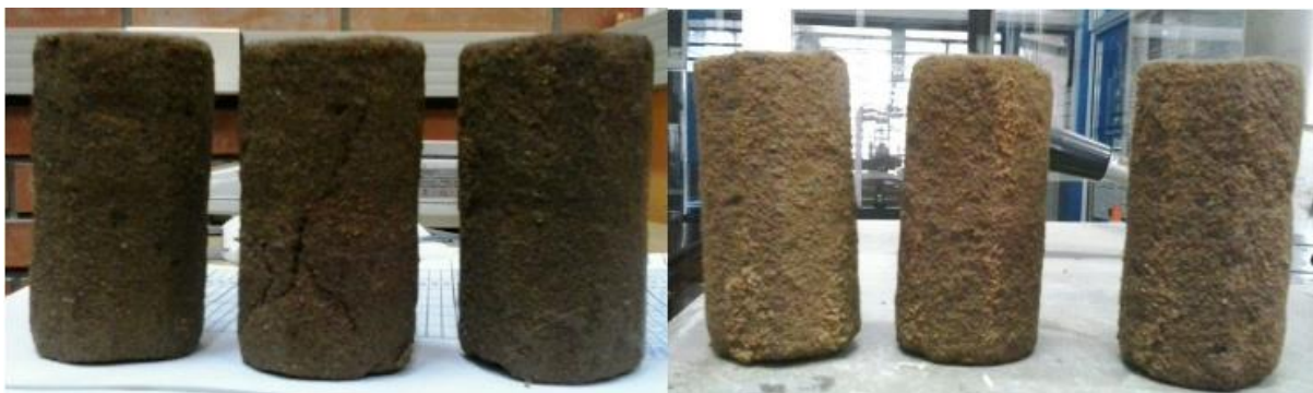
Figura 75 - Corpos de prova após ensaio de durabilidade
