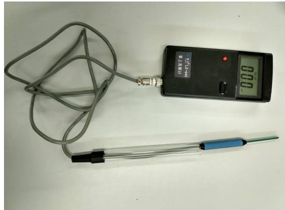
Figura 16 – Instrumento de Medição Gaussímetro
