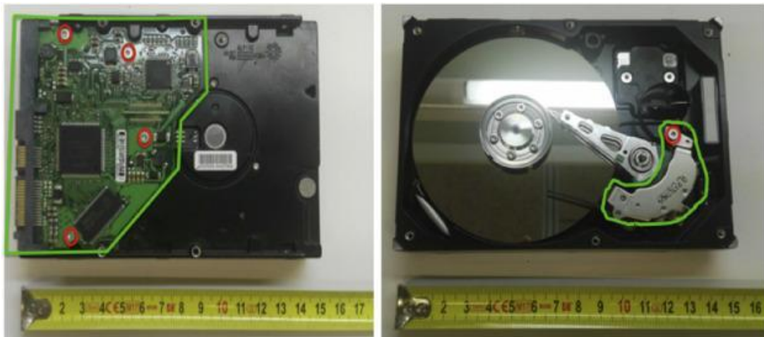
Figura 4 – Posição da placa de circuito impresso (esquerda) e ímãs permanentes (direita) na amostra de disco rígido.
