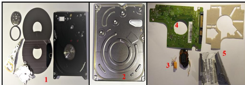
Figura 24 – Segregação do HD 2.5" (notebook) por tipo de material: 1- Metais não ferrosos, 2- Metais ferrosos, 3- Plásticos, 4- Materiais com substâncias de interesse, 5- Outros materiais.
