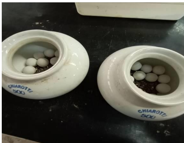
Figura 20 – Preparação da amostra a ser moída no moinho excêntrico
