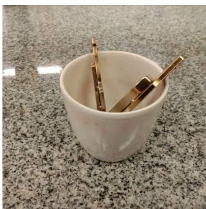
Figura 15 – Preparo de amostra no cadinho para desmagnetização
