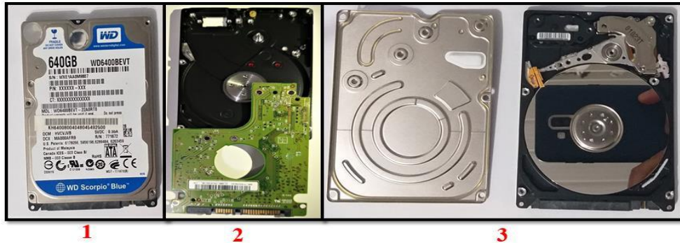
Figura 23 – HD 2.5" montado (notebook). Medidas (7×10×0,7). 1- Vista de cima, 2- Vista de baixo, 3- HD aberto
