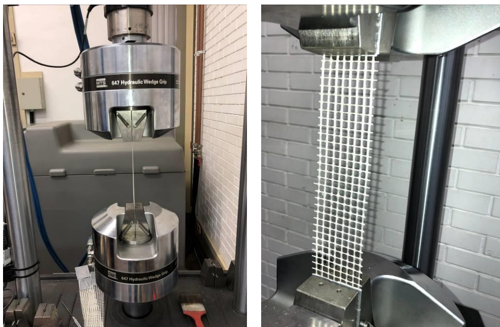
Figura 30 – (a) equipamento de ensaio MTS Landmark e (b) amostra sendo ensaiada
