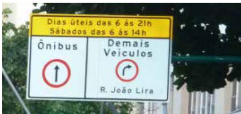
Figura 18 – Sinalização vertical placa de vias transversais com giro à direita ao longo dos corredores BRS do Rio de Janeiro
