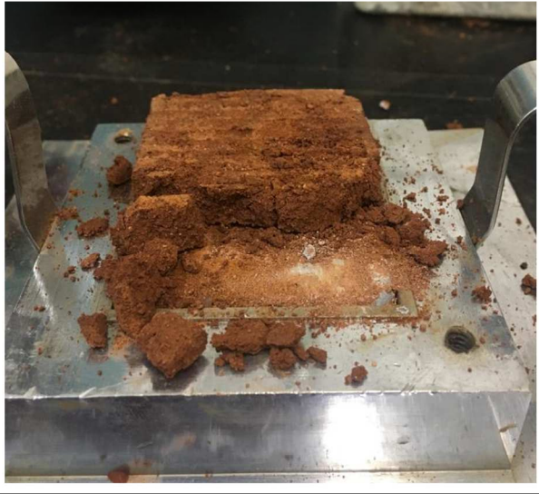
Imagem do corpo de prova cisalhado
