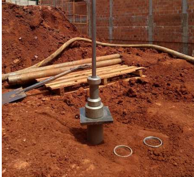
Fotografia 2 - Equipamento amostrador de solo
