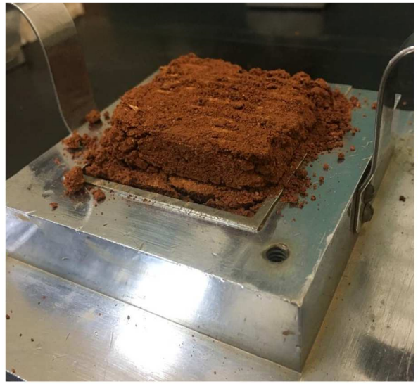
Imagem do corpo de prova cisalhado
