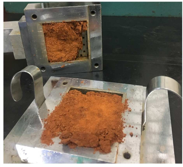
Imagem do corpo de prova cisalhado
