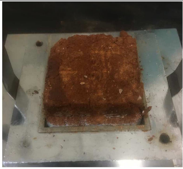
Imagem do corpo de prova cisalhado
