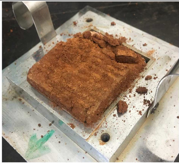
Imagem do corpo de prova cisalhado
