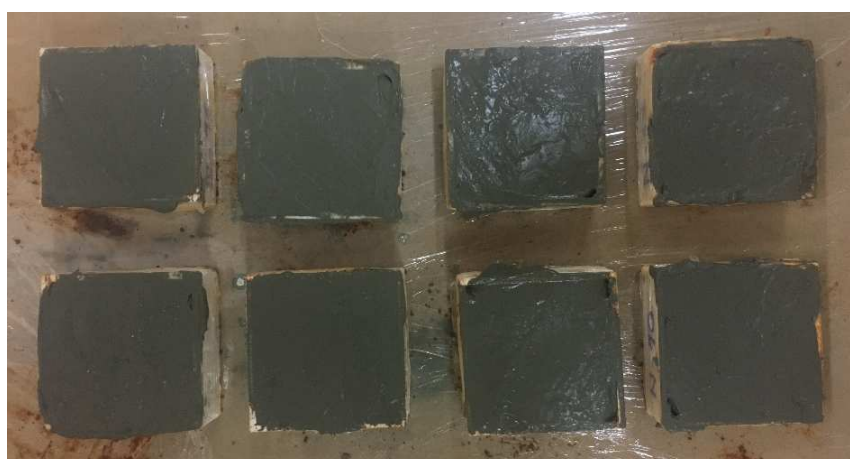
Fotografia 6 - Corpo de prova de interface preenchido com a nata de cimento
