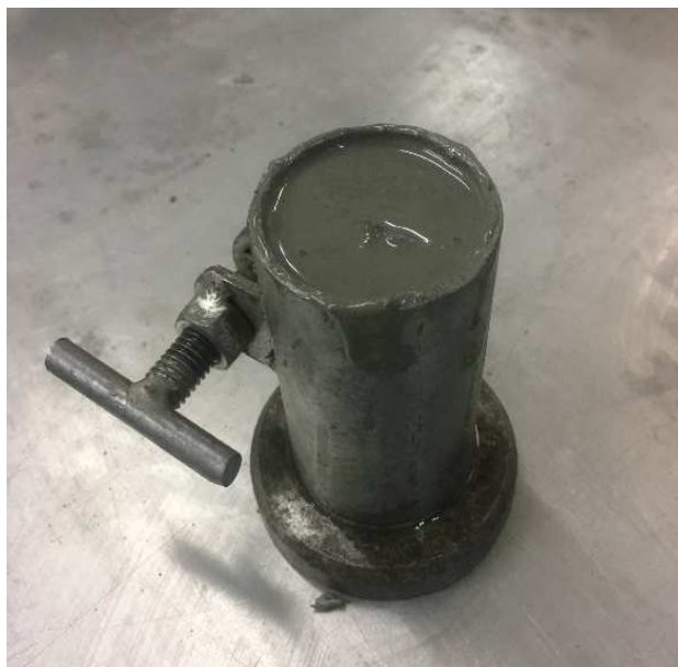
Fotografia 8 - Corpo de prova da nata de cimento
