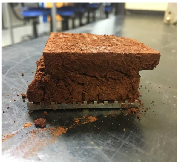
Imagem do corpo de prova cisalhado
