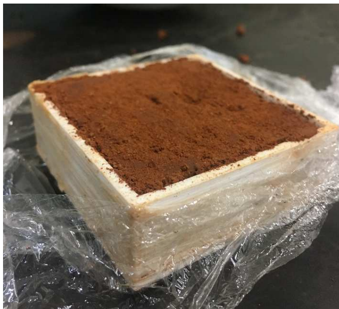
Fotografia 4 - Corpo de prova cisalhamento e molde polimérico
