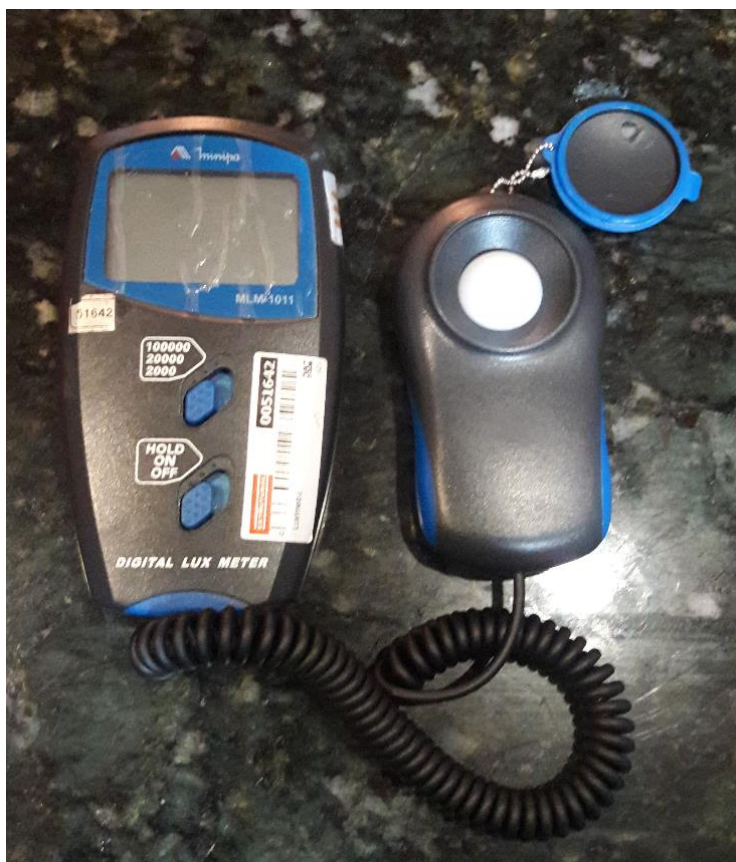
Figura 18 - Equipamento para medição de iluminância
