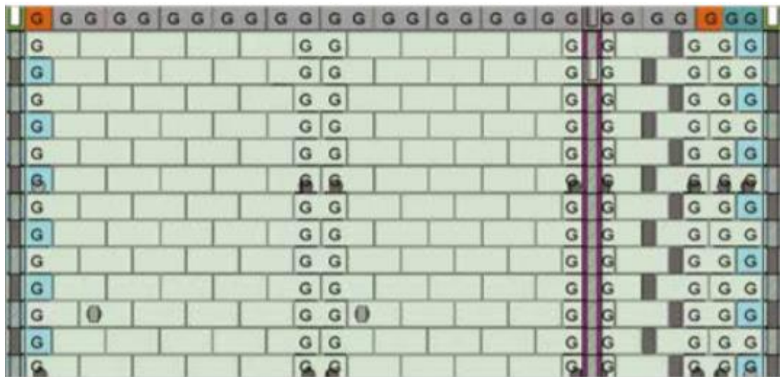
Figura 22 – Vista de uma parede com a compatibilização do graute e elétrica
