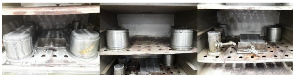
Figura 10 - Cura Térmica 65°C e 85°C
