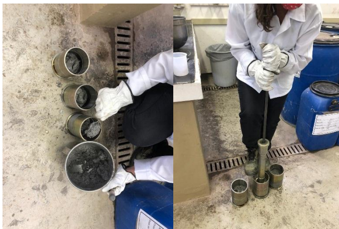
Figura 9 - Moldagem dos CPs Marshall
