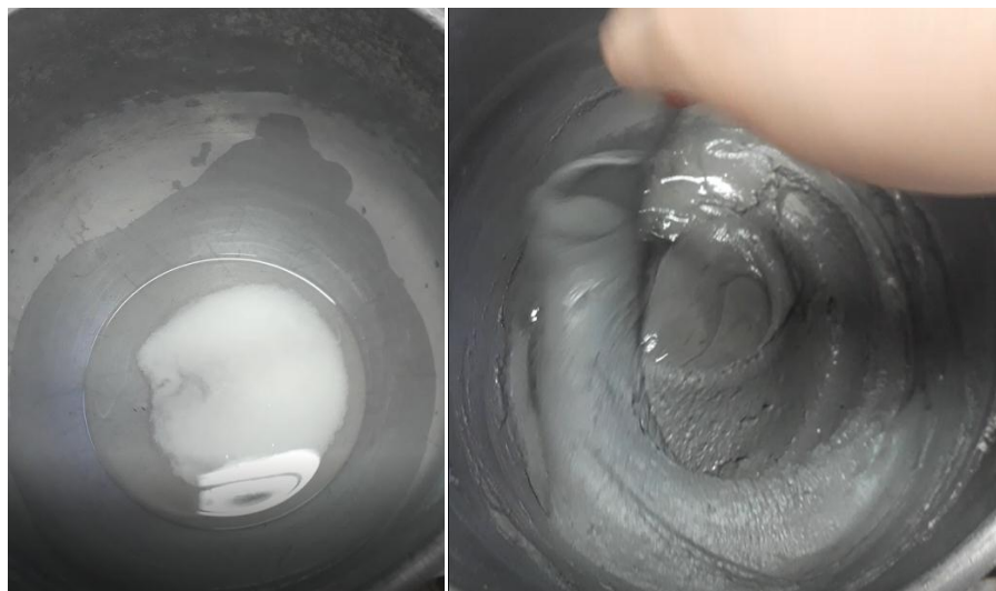
Figura 7 - Diluição do hidróxido de sódio com água e mistura do ativador com CV
