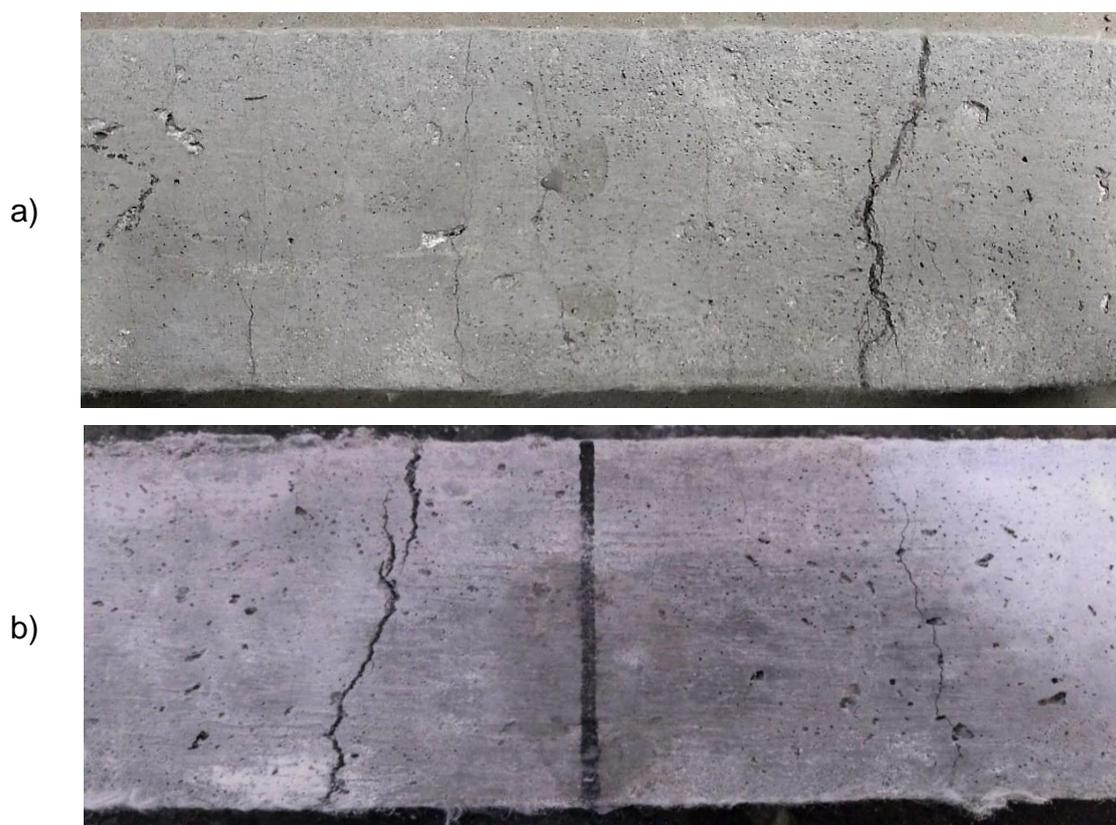
a) amostra com múltipla fissuração b) amostra sem múltipla fissuração
