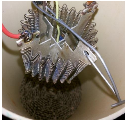
Figura 26 - Posicionamento da resistência e do papelão na seção de PVC
