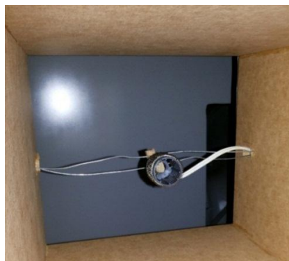
Figura 19 – Parte interna da seção com a resistência de aquecimento
