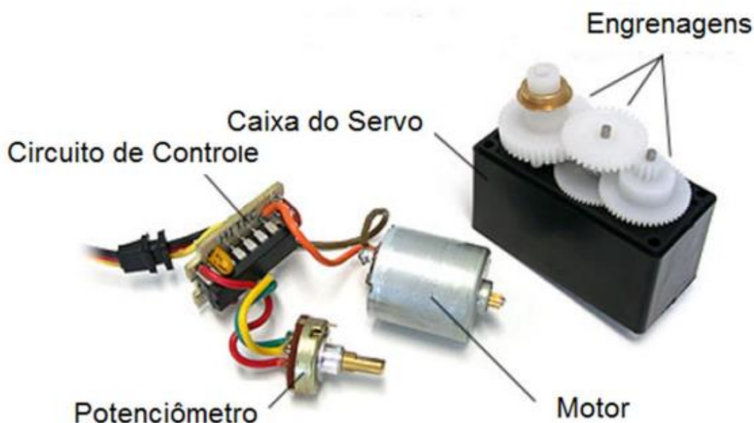
Figura 7: Componentes do Servo Motor
