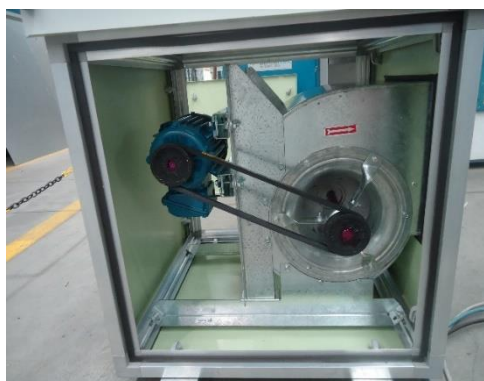
Figura 19 – Montagem de ventilador do tipo centrífugo de acoplamento indireto em uma UTA.
