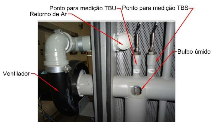
Figura 25 – Coletores de ar na entrada e saída do túnel de vento.
