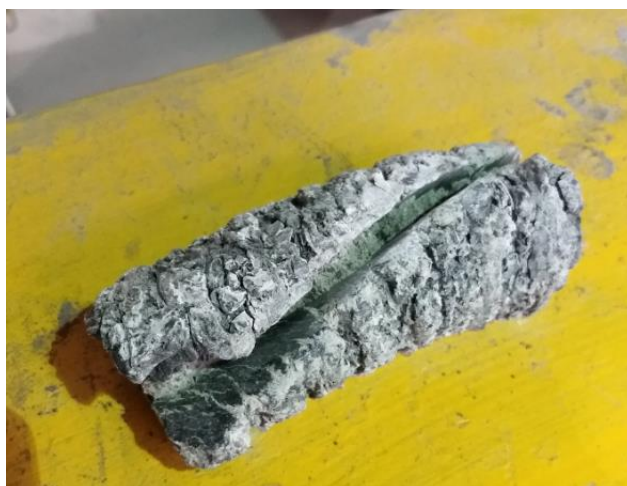
Figura 32 – Charuto formado na trefilação com a fieira 70% de comprimento de paralelo
