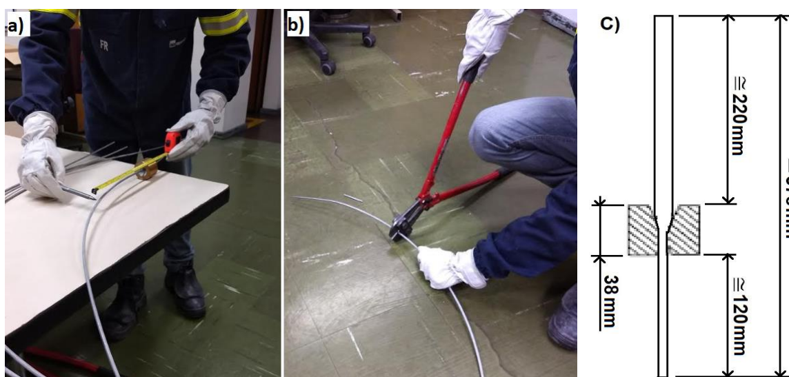
Figura 22 – a) marcação dos pontos a serem cortados, b) corte da amostra, c) ilustração de como foi alcançado o tamanho da amostra
