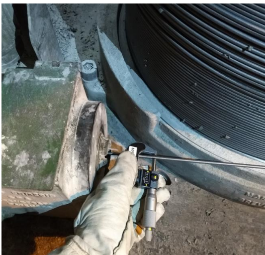
Figura 29 – Medição da deformação indireta da fieira
