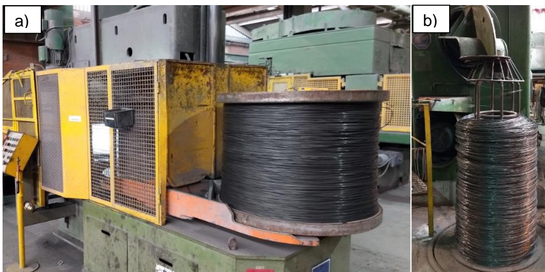
Figura 9 – Bobinador de máquinas de trefilação: a) em carretel, b) em estocador
