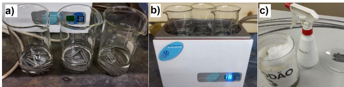
Figura 28 – a) amostras com clorofórmio, b) amostras dentro da lavadora ultrassônica, c) algodão e álcool utilizados
