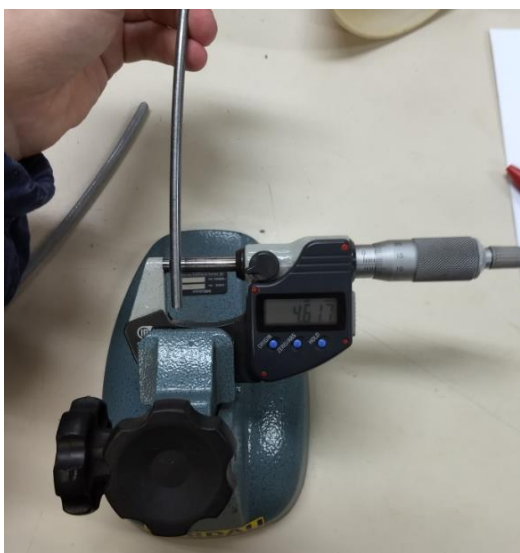
Figura 24 – Medição do dimensional das amostras
