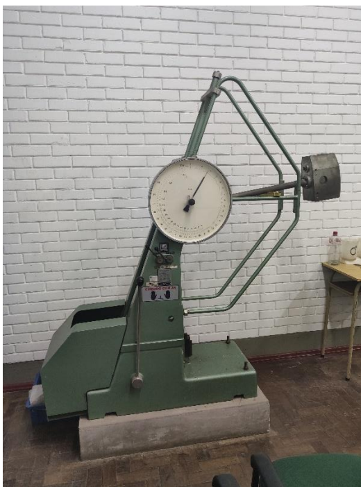
Figura 44 - Máquina utilizada para ensaio Charpy
