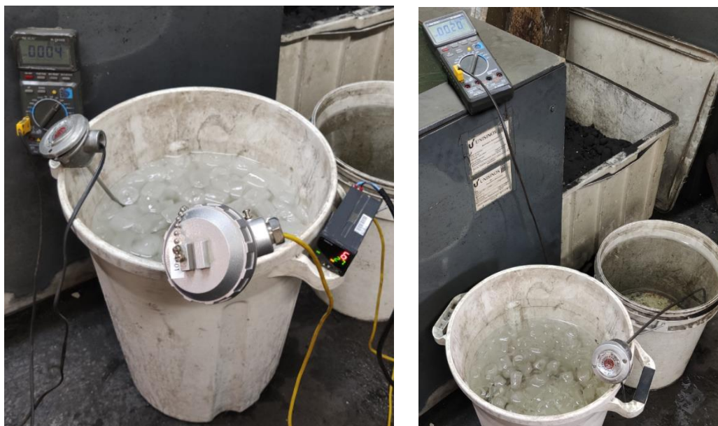
Figura 27 - Reservatórios utilizados para o resfriamento dos corpos de prova
