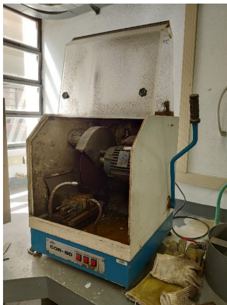
Figura 28 - Equipamento para o corte e preparação das amostras
