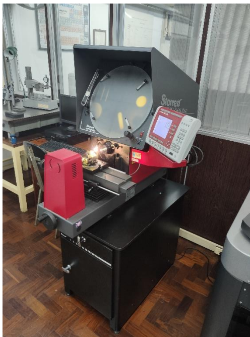
Figura 33 - Medidor óptico utilizado para análise das amostras
