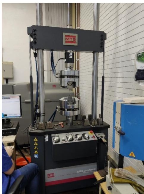
Figura 45 - Máquina utilizada para ensaio de tração
