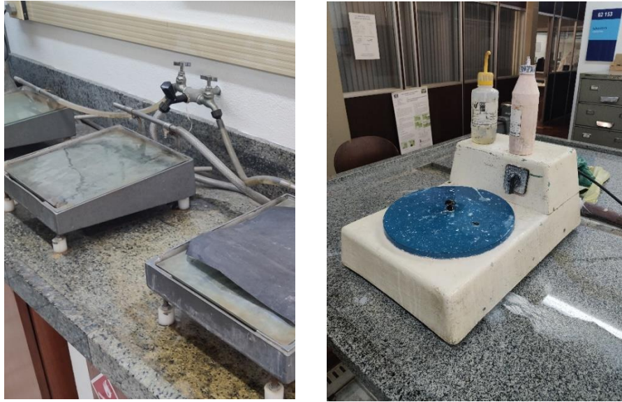
Figura 29 - Equipamentos utilizados para a preparação da superfície das amostras
