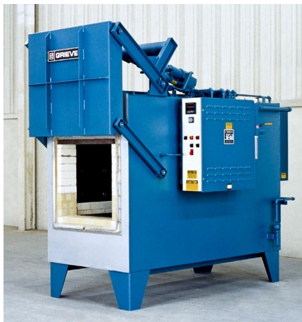
Figura 14 - Forno mufla para tratamento térmico
