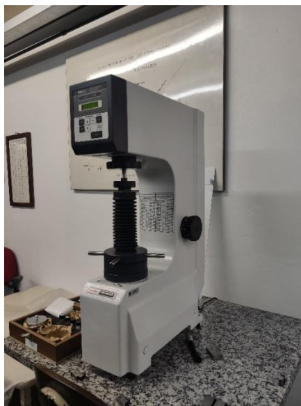
Figura 32 - Durômetro utilizado para análise das amostras
