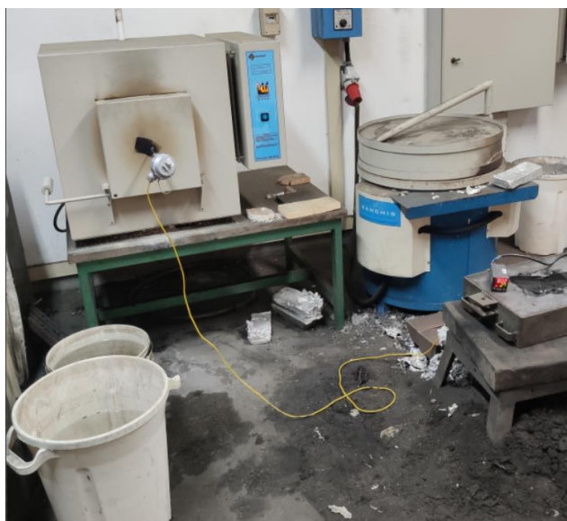
Figura 25 – Forno tipo mufla utilizado nos tratamentos térmicos
