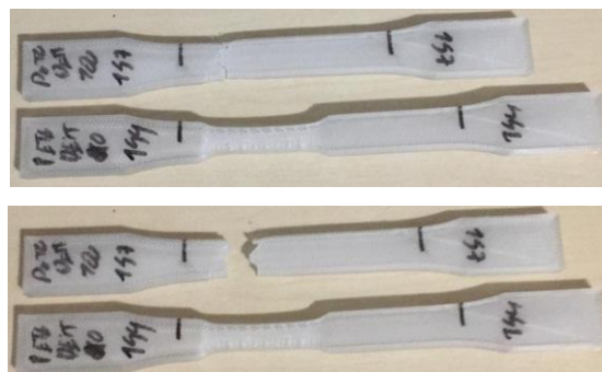
Figura 45 - Alongamento resultante nos corpos de prova fabricados na horizontal
