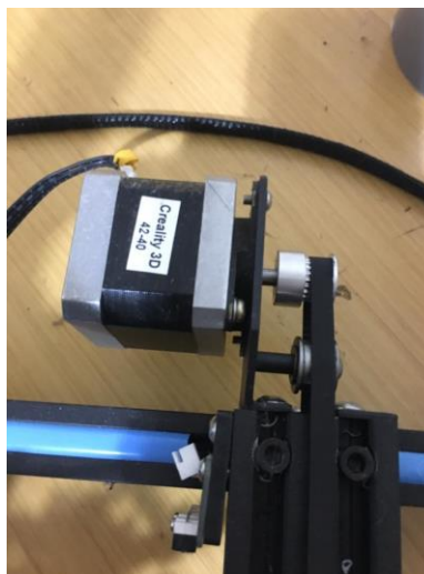
Figura 18 - Amortecedores dos acoplamentos dos motores dos eixos X e Y
