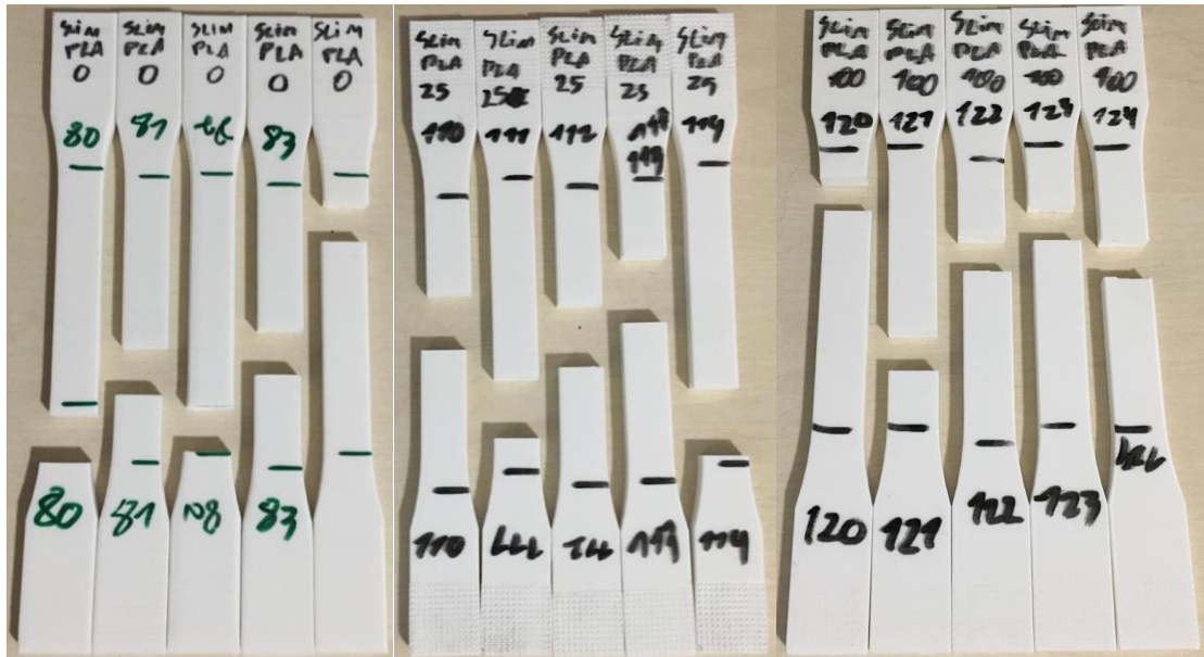
Figura 38 - Alguns dos corpos de prova do ensaio de tração para PLA Slim 3D
