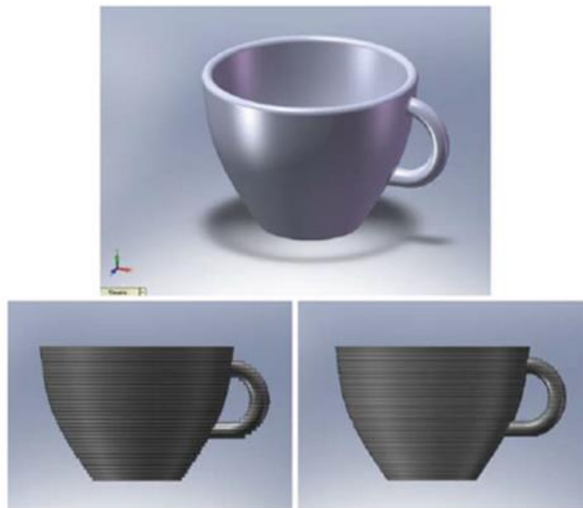
Figura 2 - Exemplos da resolução de camada em um objeto
