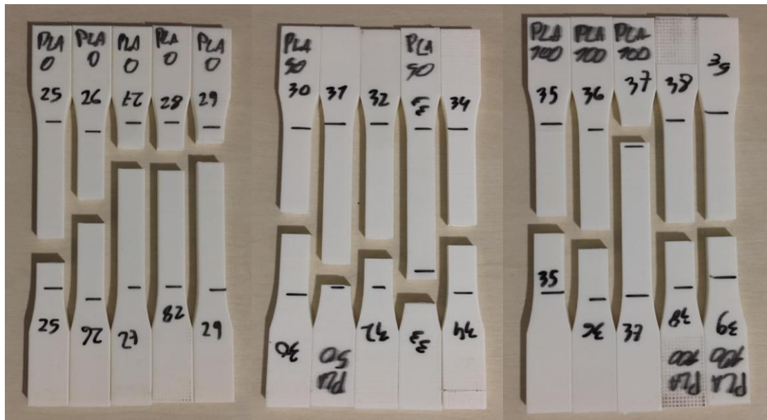
Figura 33 – Alguns dos corpos de prova do ensaio de tração para PLA 3D Fila
