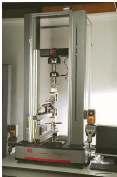
Figura 11 - Exemplo de um dispositivo de ensaio de tração
