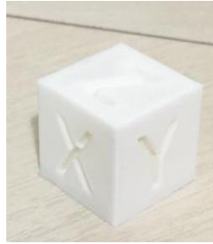
Figura 28 - Cubo de teste impresso em PLA
