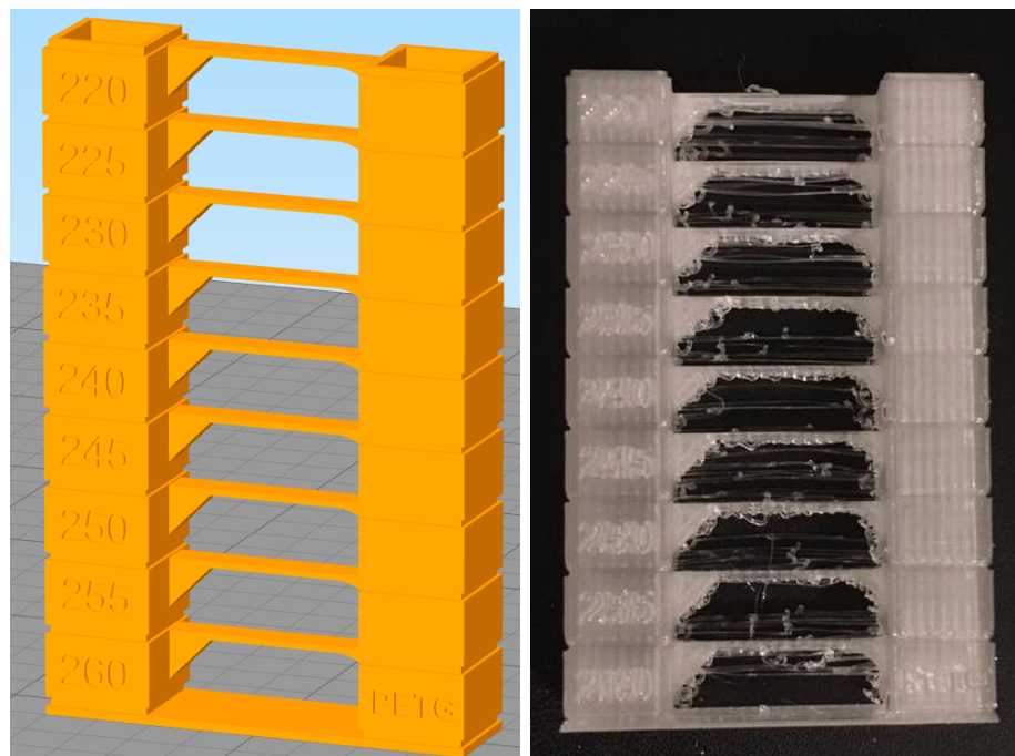
Figura 29 – Torre de temperatura para PETG
