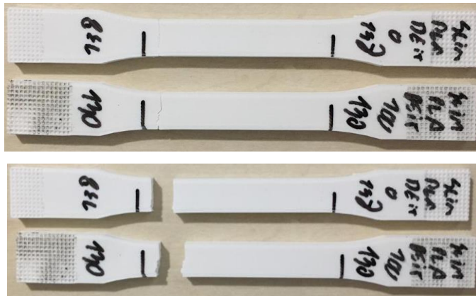
Figura 41 - Alongamento resultante nos corpos de prova fabricados na horizontal
