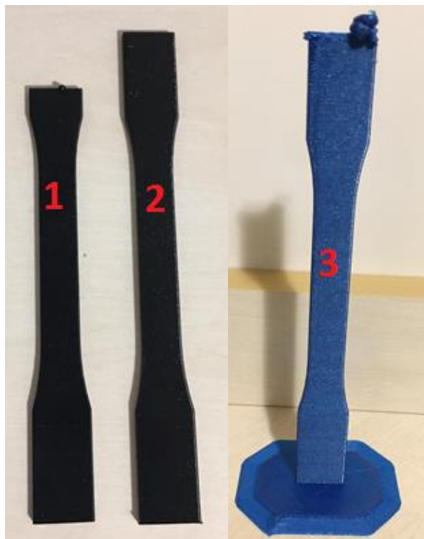
Figura 24 – Tentativas de imprimir o corpo de prova com 3,2 mm de espessura
