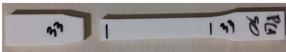
Figura 34 – Corpo de prova onde ocorreu quebra fora da região desejada
