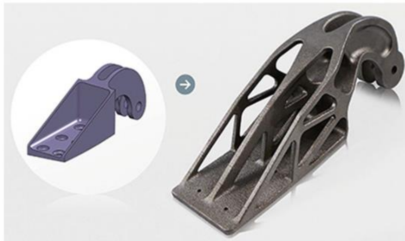
Figura 1 - Dobradiça do AirBus A320
