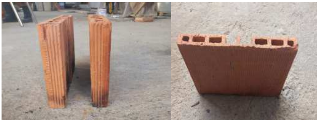
Figura 15 - Placas cerâmicas cortadas
