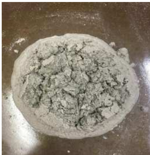
Figura 19 - Ensaio de índice de consistência - AABB sem aditivo
