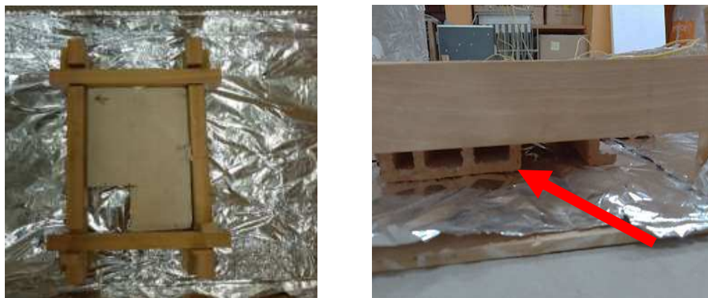
Figura 31 - Sistema de restrição em madeira de Grápia
