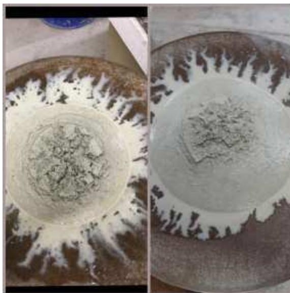
Figura 20 - Ensaio de índice de consistência - AABQ e AABB com aditivo
