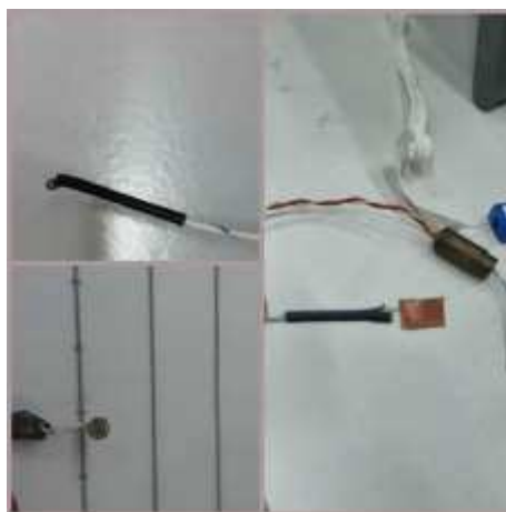
Figura 27 - Termopares de haste flexível
