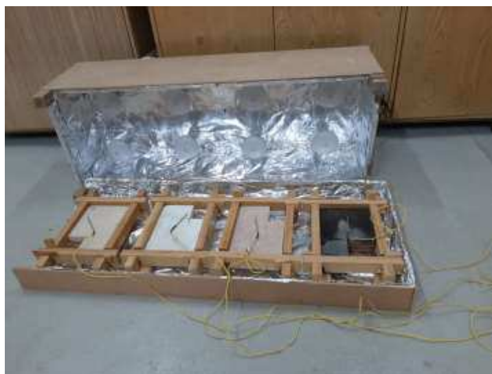
Figura 30 - Caixa térmica modificada - parte interna
