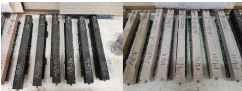
Figura 22 - Amostras para ensaio de variação dimensional e variação de massa
