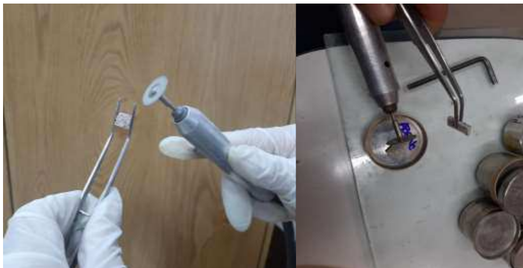
Figura 35 - Caneta e disco diamantado odontológicos
