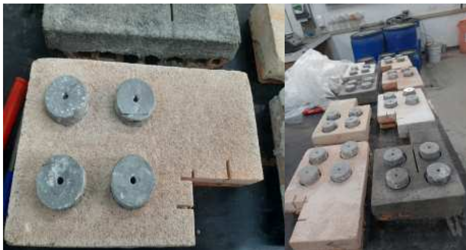
Figura 32 - Pastilhas aplicadas no sistemas de revestimento
