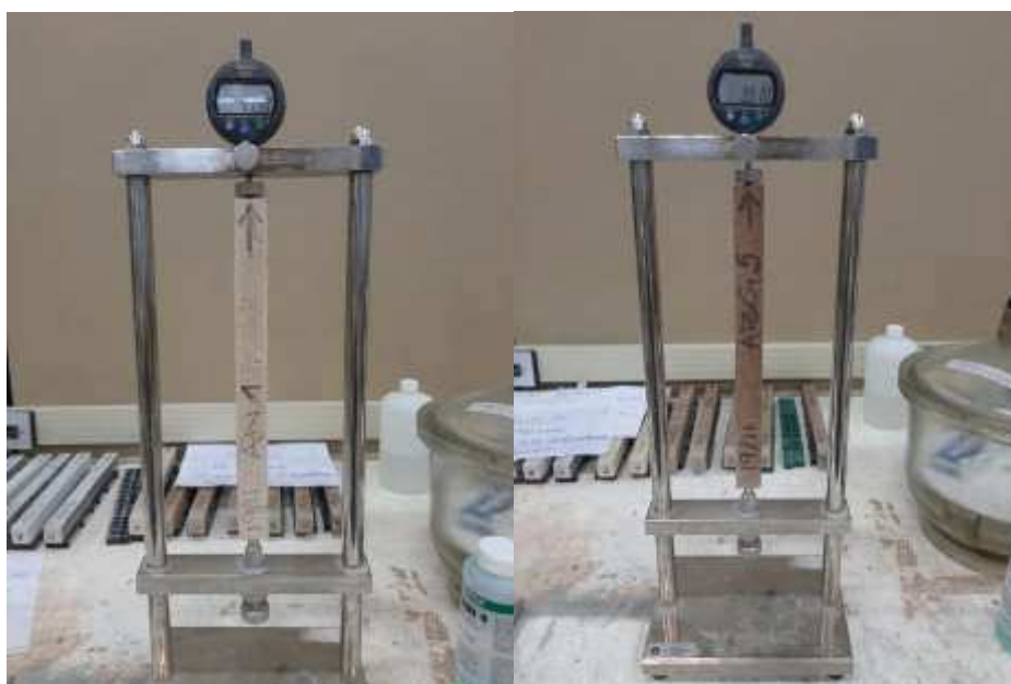
Figura 23 - Ensaio de Variação dimensional e variação de massa
