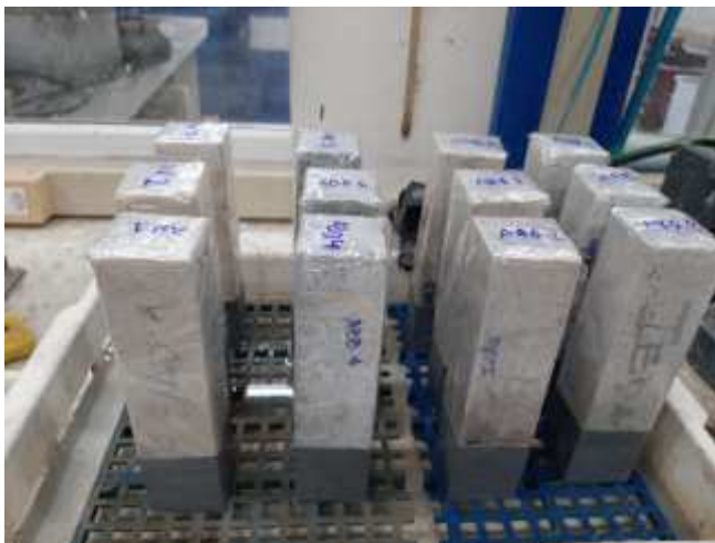
Figura 21 - Ensaio de absorção por capilaridade
