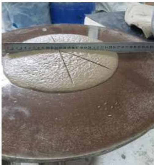
Figura 18 - Ensaio de índice de consistência - AAN
