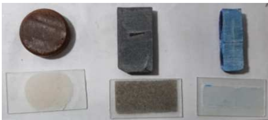
Figura 14 - Lâminas delgadas das amostras de agregado
