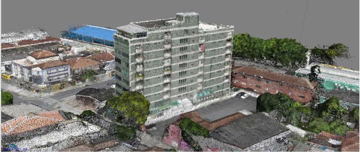
Figura 35 – Nuvem de pontos RGB resultante do levantamento com o M2EA
