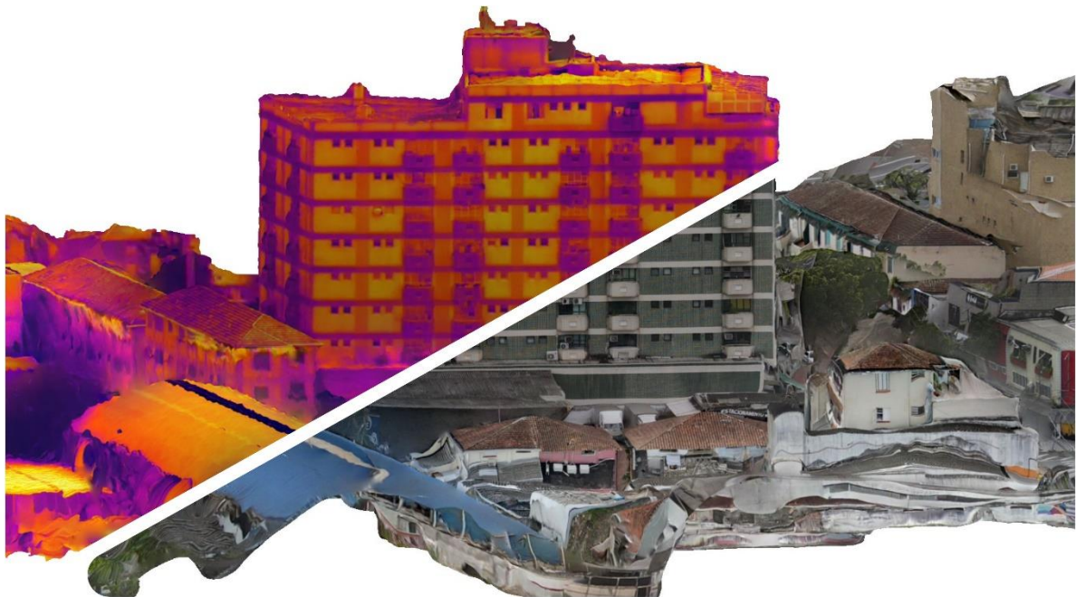
Figura 42 – Comparação entre mosaicos IR e RGB da fachada Leste
