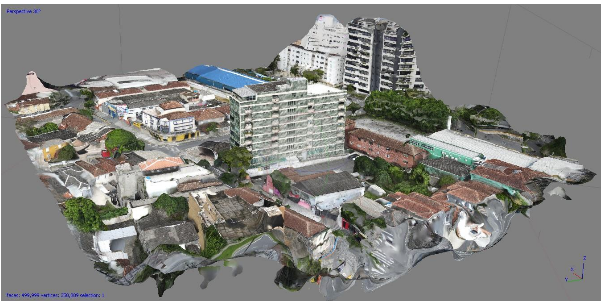
Figura 37 – Modelo 3D com textura RGB resultante do levantamento com o M2EA
