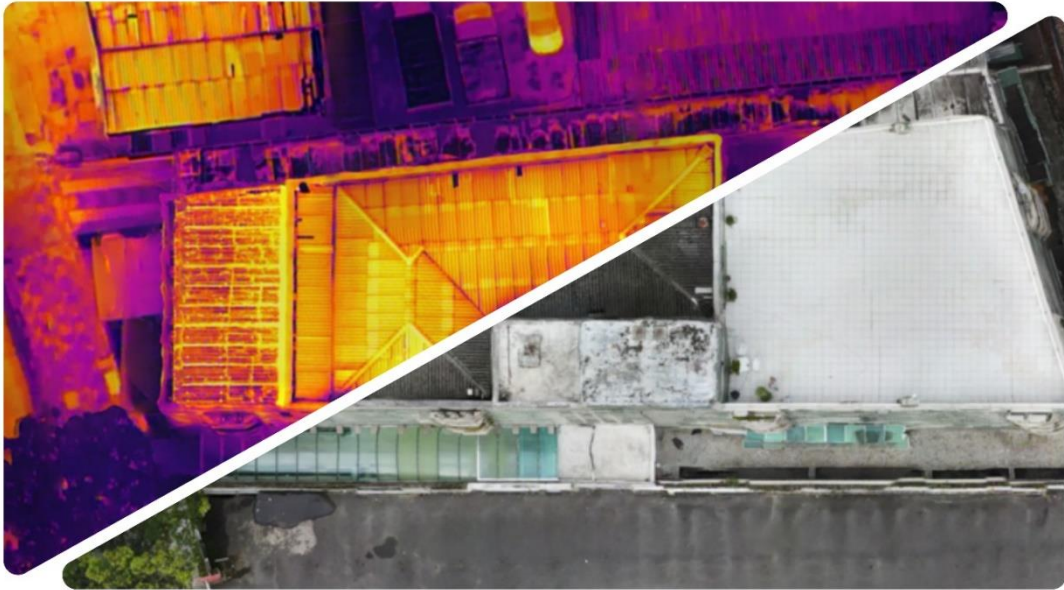
Figura 38 – Comparação entre mosaicos IR e RGB da cobertura
