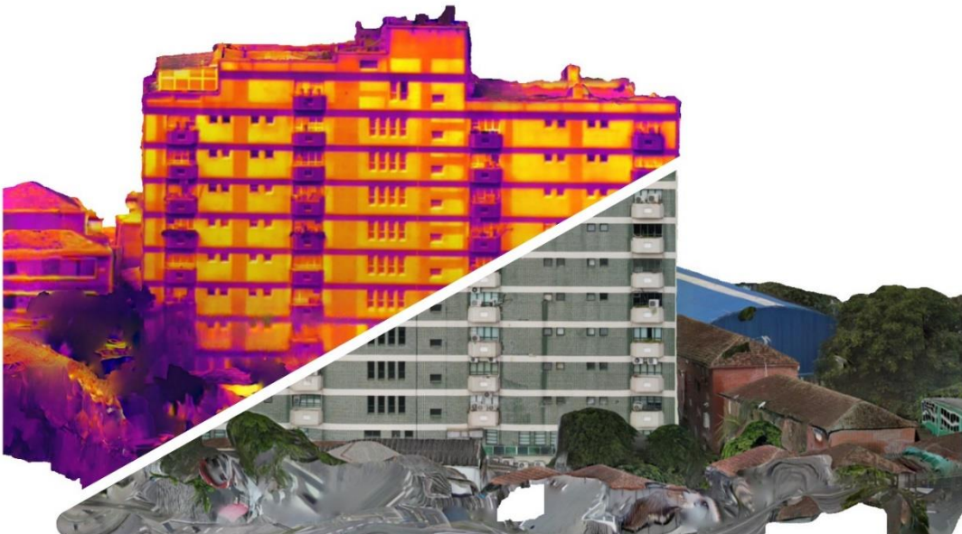
Figura 39 – Comparação entre mosaicos IR e RGB da fachada Oeste
