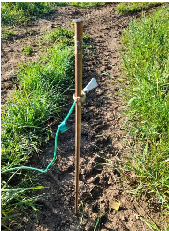
Figura 19 – Eletrodos fincados no solo com conector inserido.
