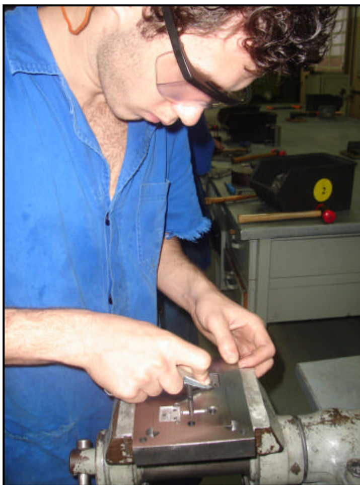
Figura 12: Aluno aplicando acabamento e ajuste à ferramenta
