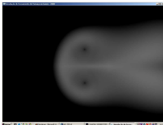
FIGURA 2.12 – (Hardt [10]) - Aprisionamento da fumaça em vórtices.
