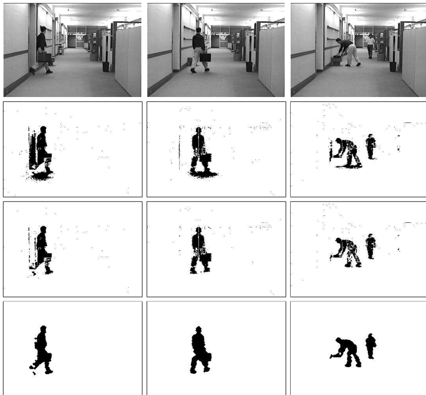
Figura 34: Primeira linha: quadros de uma seqüência de vídeo. Segunda linha: objetos do foreground detectados com a técnica de subtração de fundo descrita. Terceira linha: remoção da sombra. Quarta linha: resultado após aplicação de operadores morfológicos de pós-processamento
