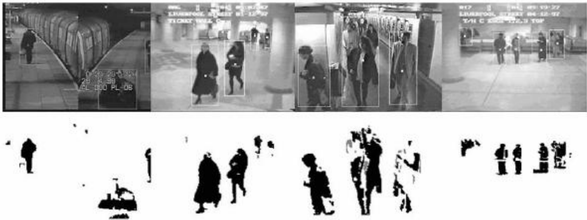
Figura 5: Acompanhamento de pessoas através de matrizes combinadas com seus respectivos blobs segundo (FUENTES; VELASTIN, 2005)
