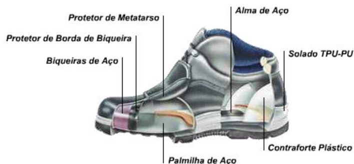
Figura 10: Disposição de Alguns Componentes no Calçado de Segurança
