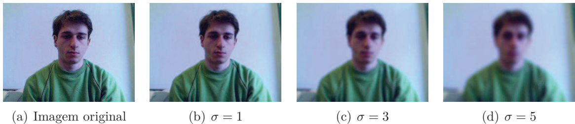
Figura 2.10: Exemplo da aplicação de um filtro Gaussiano 2D no domínio espacial.
