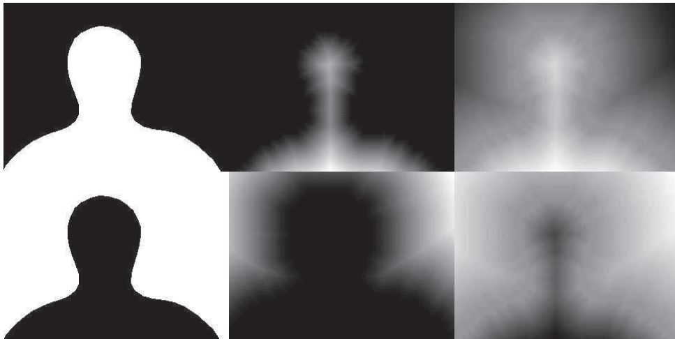
Figura 4.6: Primeira linha refere-se ao cálculo da probabilidade a priori do primeiro plano, e a segunda, do segundo plano. Primeira coluna: resultado da segmentação utilizando informação de movimento; Segunda coluna: Transformada Distância; Terceira coluna: Probabilidade a priori .
