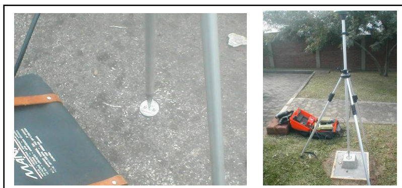
Figura 3 - Materializações de pontos utilizados no projeto da rede GPS
