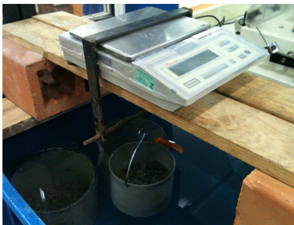
Figura 12 – Ensaio de absorção de água do AGN e AGRC.
