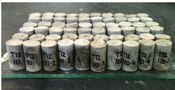
Figura 24 – Amostras de argamassa desmoldadas e identificadas.
