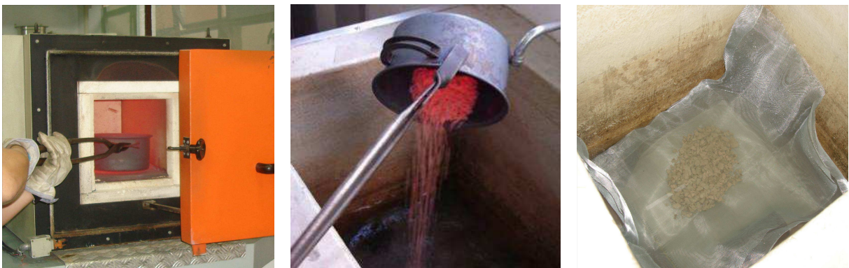
Figura 14 – Primeira etapa do ensaio para determinação do teor de argamassa aderida ao AGRC – choque térmico no AGRC.
