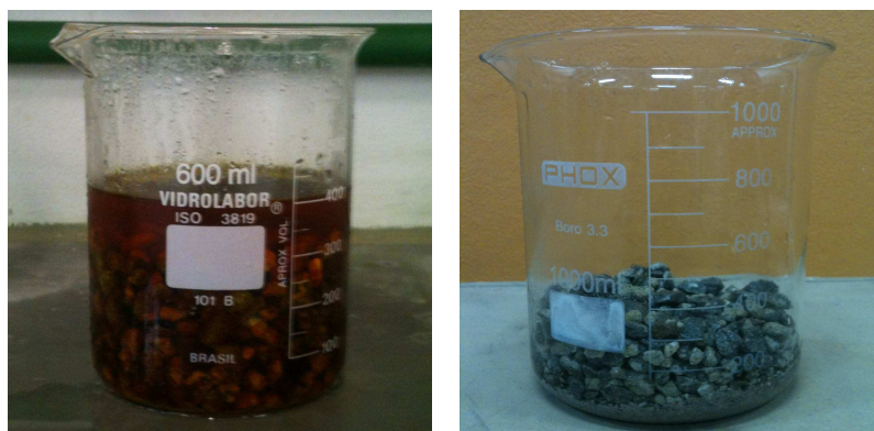
Figura 16 – Segunda etapa do ensaio para determinação do teor de argamassa aderida ao AGRC – imersão em ácido clorídrico e material após ataque químico.
