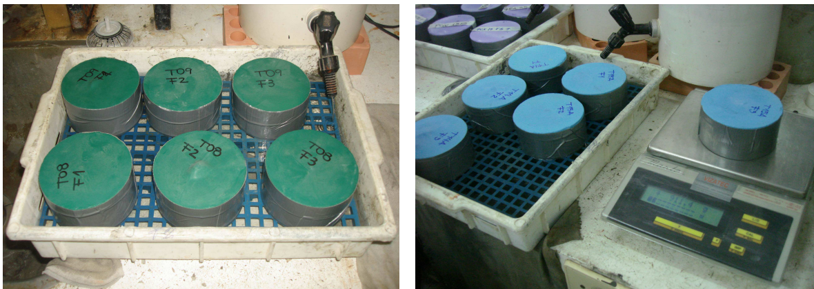
Figura 22 – Etapas do ensaio de absorção de água por capilaridade.
