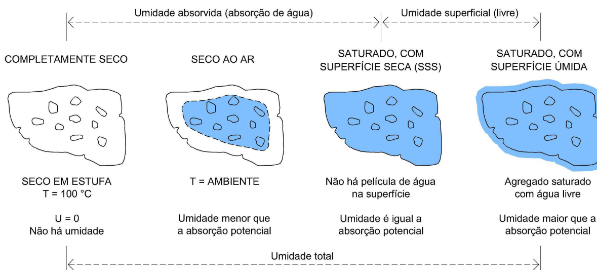
Figura 7 – Representação esquemática das condições de umidade do agregado.
