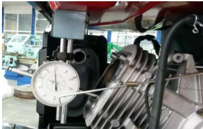
Figura 3.4 – Identificação do PMI do motor.
