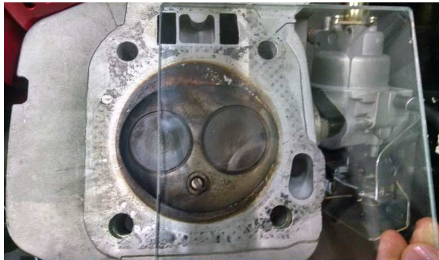
Figura 3.7 – Identificação do volume da câmara de combustão.
