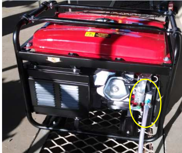
Figura 3.22 – Alimentação de biogás no motor.
