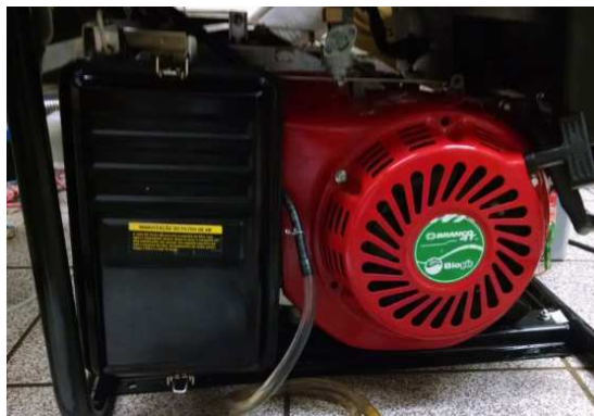
Figura 3.26 – Alimentação de combustível líquido
