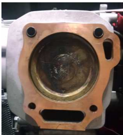
Figura 3.8 – Juntas de cobre utilizadas para reduzir a razão de compressão do motor.
