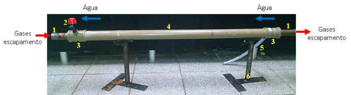
Figura 3.10 – Trocador de calor construído para realização do estudo.
