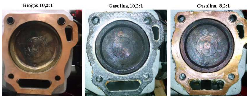
Figura 4.7 – Topo do pistão após os testes.
