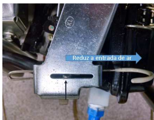
Figura 3.27 – Posição do afogador nos testes realizados de 0 a 50% de carga.
