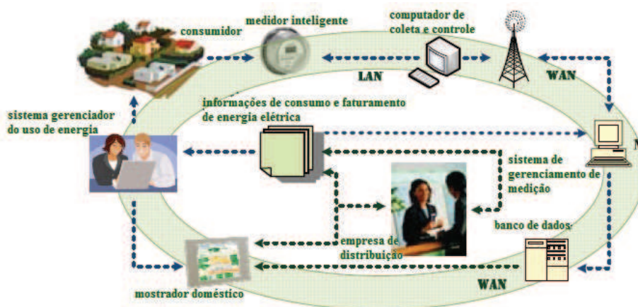
Figura 9: Composição, estrutura e diagrama de fluxo de dados de uma rede AMI.
