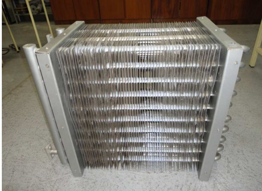
Figura 4.10 - Trocador de calor utilizado no experimento.
