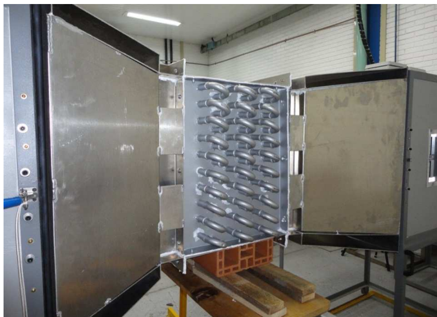
Figura 4.11 – Montagem do trocador de calor no túnel experimental.
