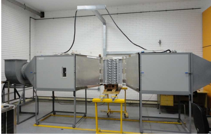
Figura 4.12 - Montagem do trocador de calor no túnel experimental.
