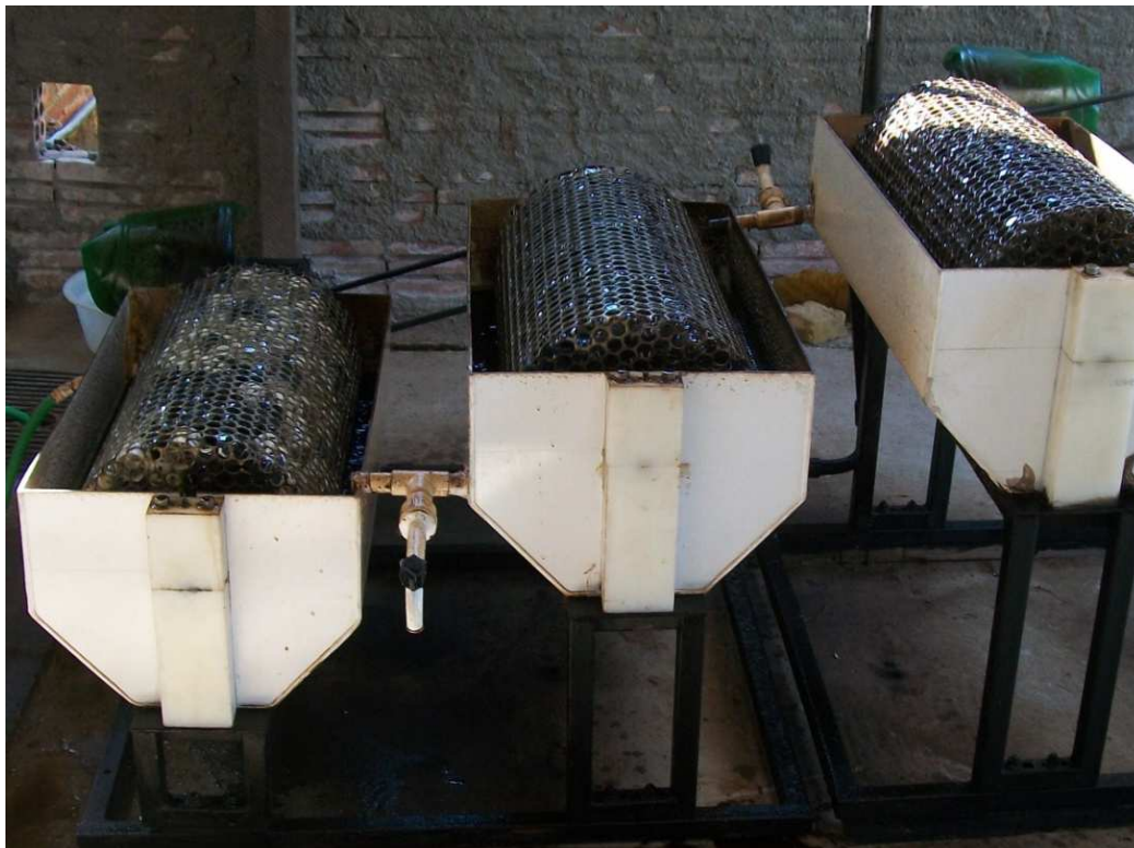
Figura 5 - Contactor biológico rotatório utilizado no experimento.
