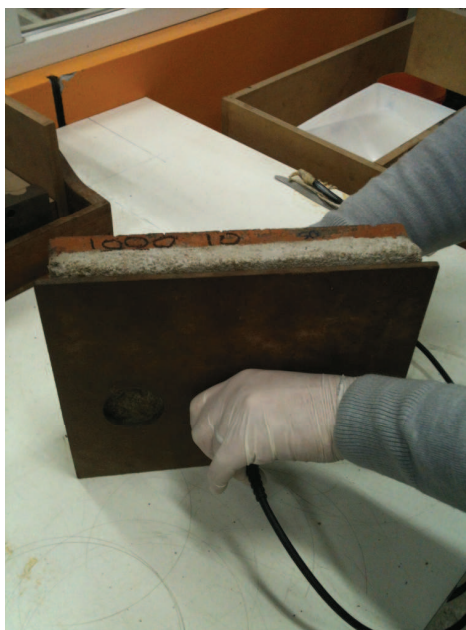
Figura 23 - Medição da velocidade de propagação de ondas ultrassônicas, pelo método direto, no conjunto de revestimento.
