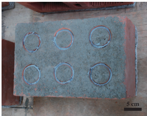
Figura 22 – Preparação do bloco chapiscado para o ensaio de resistência de aderência à tração.
