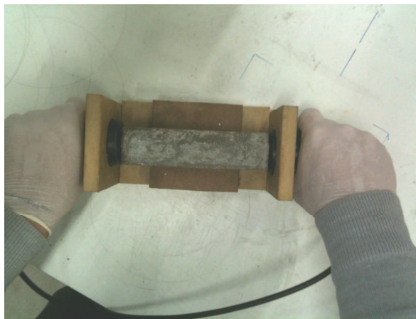
Figura 21 - Tomada da velocidade de propagação de ondas ultrassônicas das argamassas, pelo método direto.
