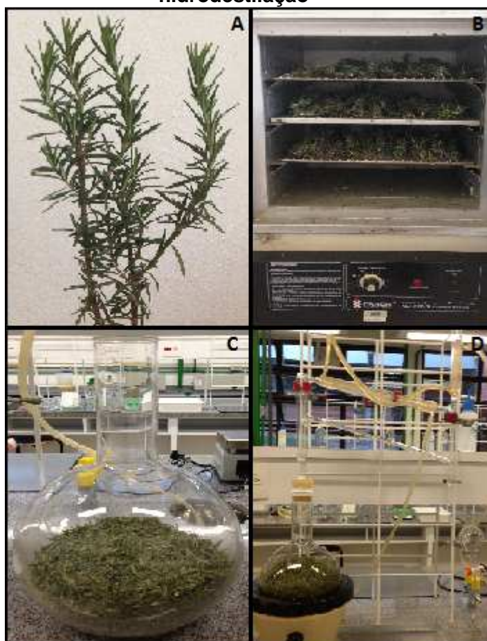
Figura 5 – Fotografias de etapas do processo de obtenção do óleo essencial de alecrim. A – Alecrim fresco, B – Etapa de desidratação, C – Balão de destilação do Aparelho Clevenger com as folhas trituradas e D – Aparelho Clevenger para hidrodestilação
