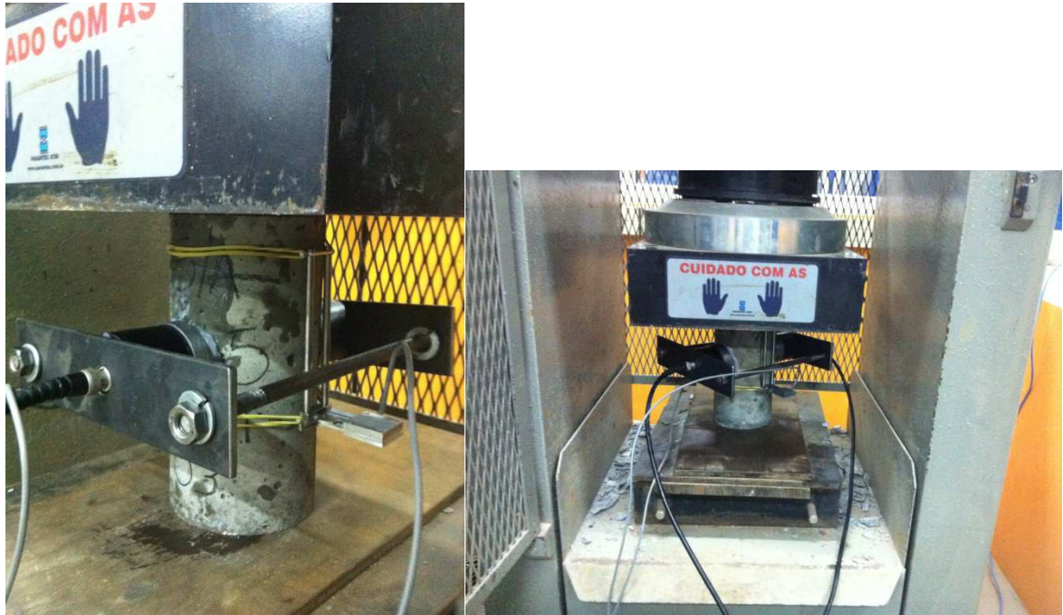
Figura 28 – Corpos de prova com sensores do ultrassom e clip gauges ensaiados na prensa hidráulica.
