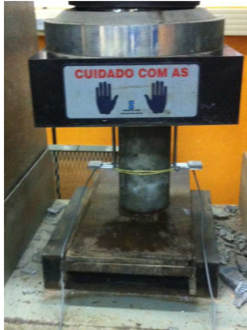
Figura 23 – Clip gauges do Data Logger acoplados no corpo de prova cilíndrico.
