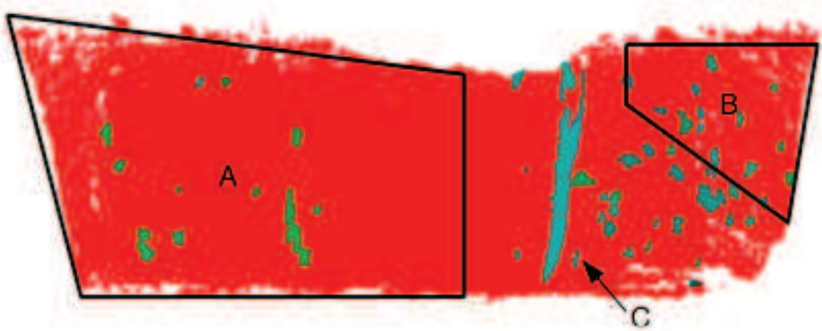
Figura 25: Planos encontrados na nuvem de pontos do afloramento quando o parâmetro de ajuste dos pontos ao plano foi aumentado.
