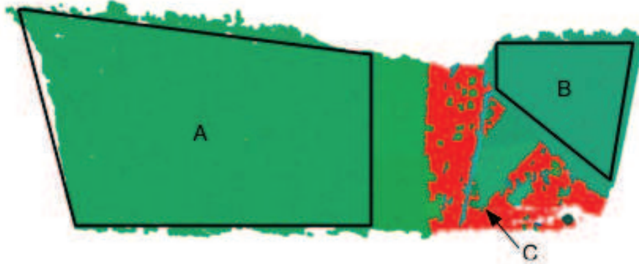
Figura 24: O processamento dos dados do afloramento para m \geq 5 encontrou grandes planos em áreas com deformidades, mas que satisfazem os parâmetros do algoritmo.
