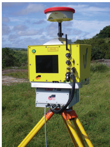
Figura 5: LASER Scanner Terrestre Optech ILRIS3D com equipamento de georreferenciamento acoplado.
