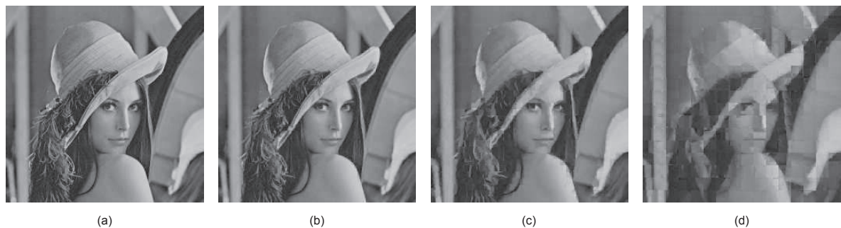
Figura 27: Observando a imagem resultante com o algoritmo de compressão Fractal: (a) imagem original; (b) imagem com 16384 domínios; (c) imagem com 4096 domínios; (d) imagem com 1024 domínios.
