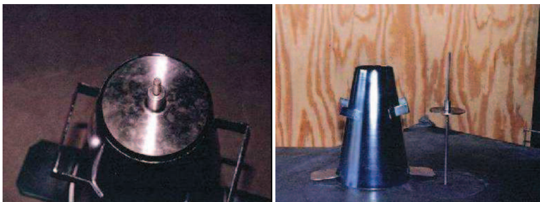
Figura 5 – Modificações do equipamento para realização do ensaio de abatimento Fonte: FERRARIS E DE LARRARD (1998)
