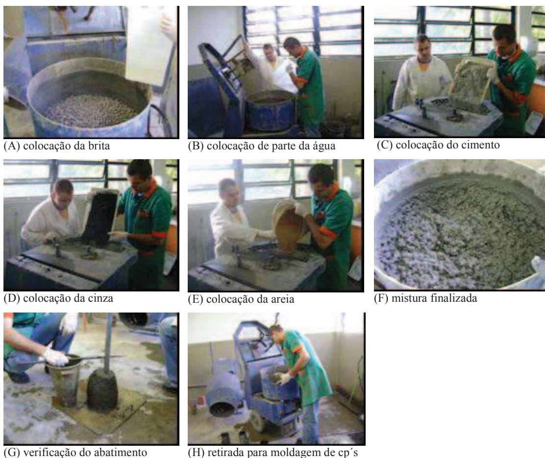
Figura 23 - Produção do concreto para moldagem dos cp's
