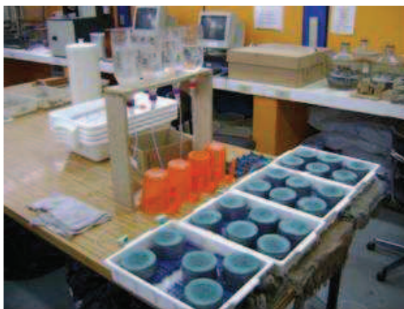
Figura 30 – Execução do ensaio de absorção por capilaridade
