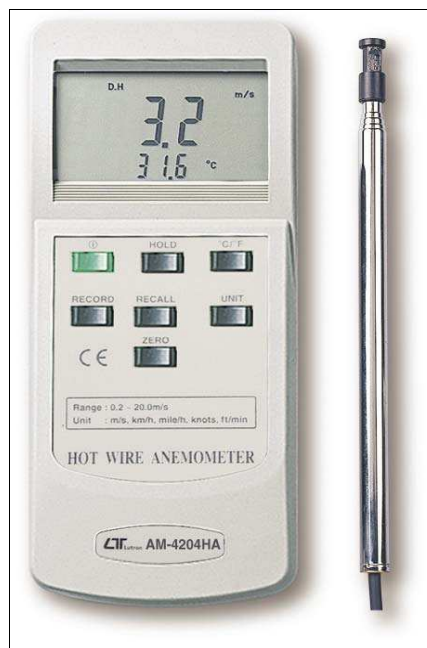
Figura 3.9 – Anemômetro portátil utilizado para medir a velocidade do ar.
