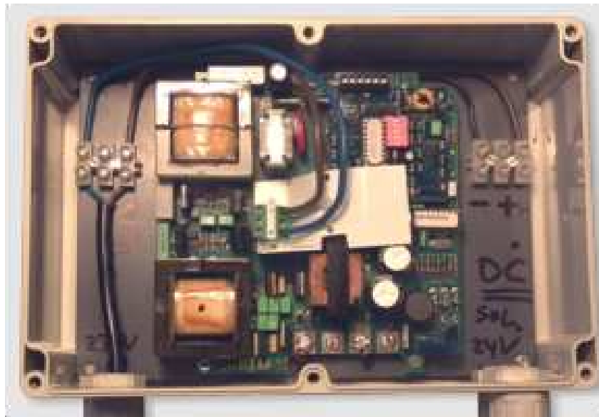
Figura 2.11 - Vista interna do microinversor SUNMASTER 130S. Fonte: SUNMASTER ... (2011).
