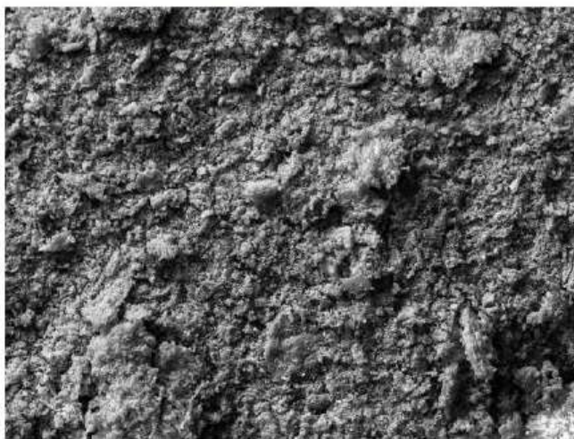
Figura 47 – Imagem obtida por detector de elétrons secundário em microscópio eletrônico de varredura – Cinzas 2013.
