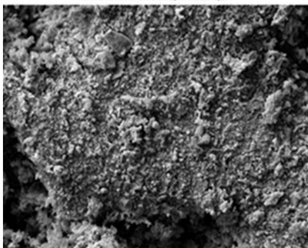
Figura 43 – Imagem obtida por detector de elétrons secundário em microscópio eletrônico de varredura – Cinzas 2005.
