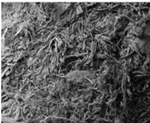
Figura 35 – Imagem obtida por detector de elétrons secundário em microscópio eletrônico de varredura – Aparas 2005.
