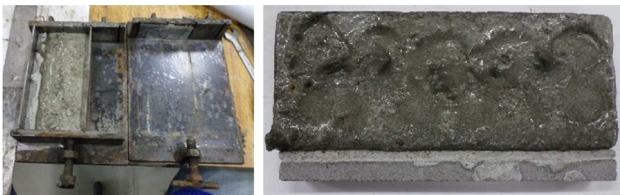
Figura 25 - CARC-M antes (à esquerda) e após a desforma (à direita).
