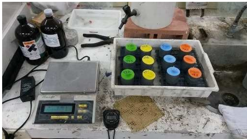
Figura 21 - Ensaio de absorção de água por capilaridade.
