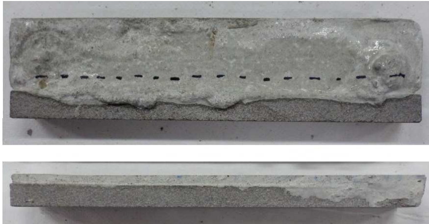
Figura 24 - ARC-M antes (Figura superior) e após o corte (Figura inferior).
