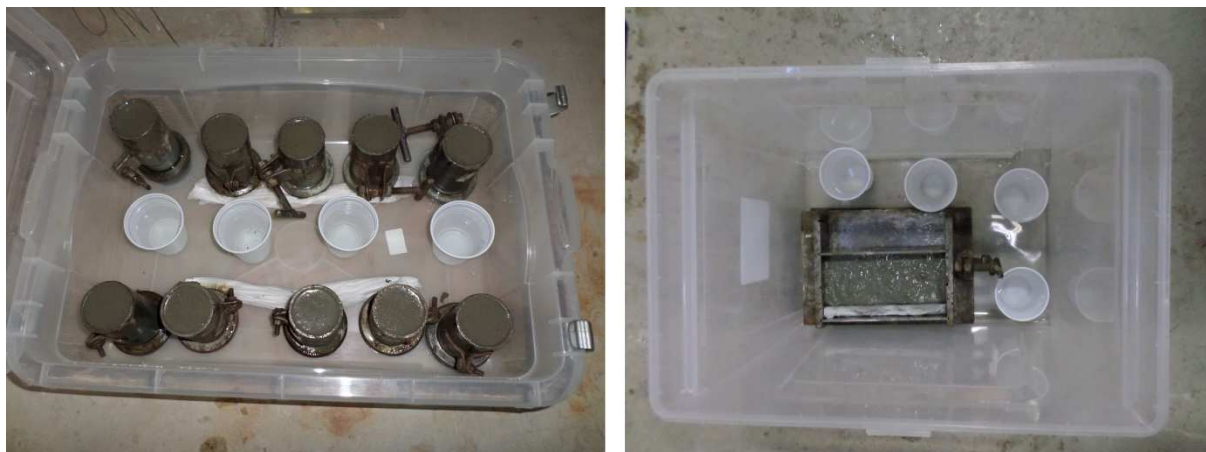
Figura 19 - Cura inicial dos corpos de prova.
