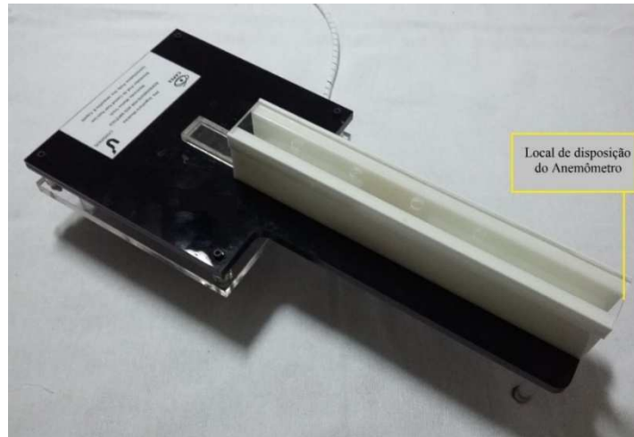
Figura 5.20 – Indicação do local onde foi disposto o anemômetro de fio quente.
