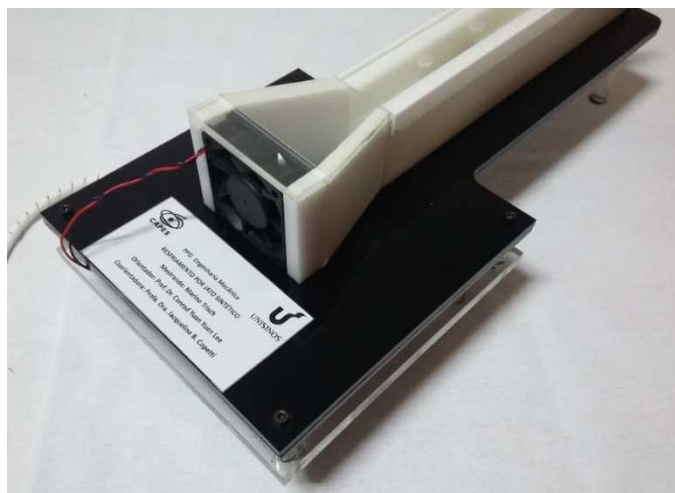
Figura 5.16 – Cooler de 53 mm acoplado ao duto da bancada experimental.
