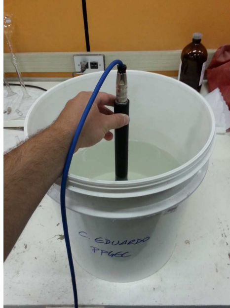
Figura 17 – Realização do ensaio de calibração da sonda com soluções de resistividades conhecidas.
