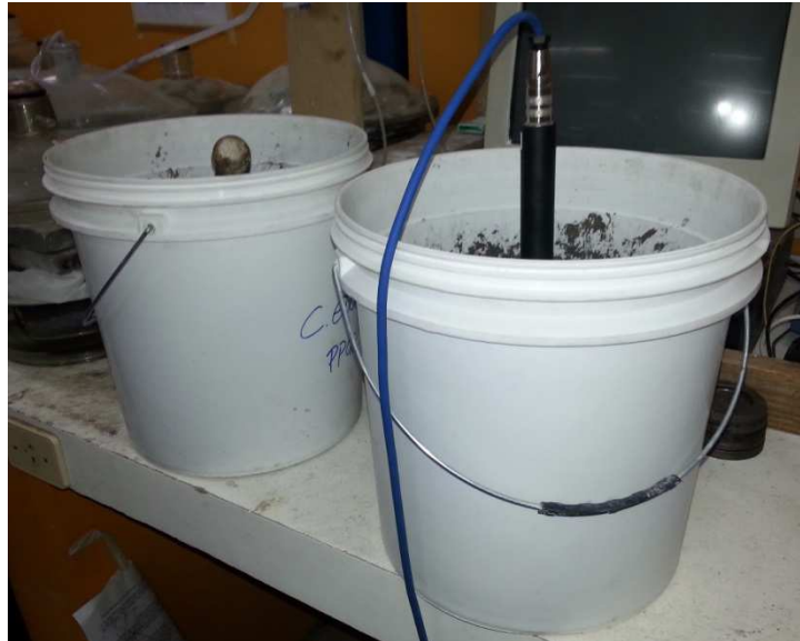
Figura 20 – Recipiente utilizado para realização dos ensaios de resistividade elétrica.
