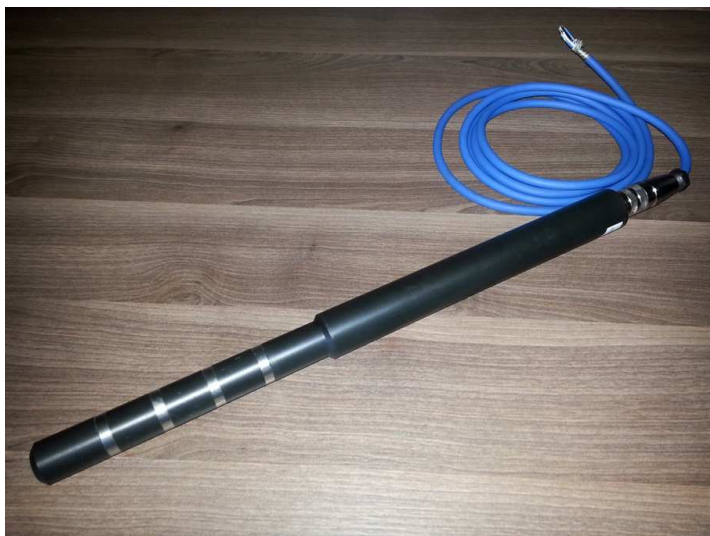
Figura 16 – Equipamento utilizado na realização dos ensaios de resistividade elétrica.
