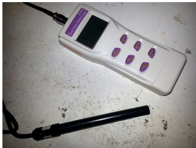
Figura 18 – Condutivímetro utilizado na calibração das soluções.
