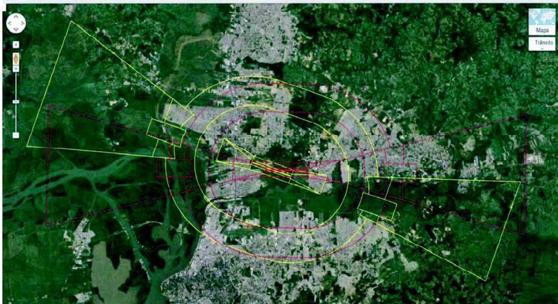
**Figura 27 – Croqui do Plano Básico de Zona de Proteção do Aeródromo de Canoas com duas pistas.**
