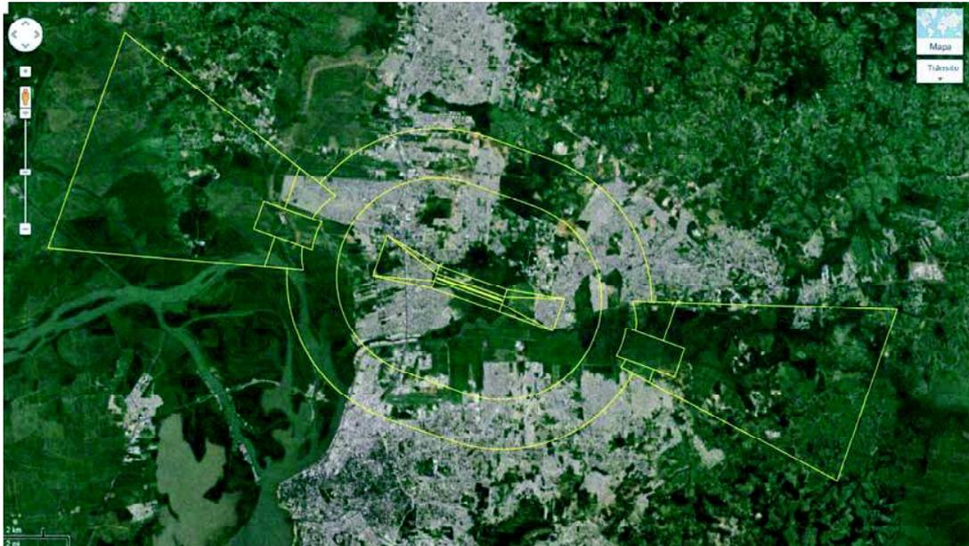
**Figura 26 – Croqui do Plano Básico de Zona de Proteção do Aeródromo de Canoas em fase de elaboração e aprovação.**
