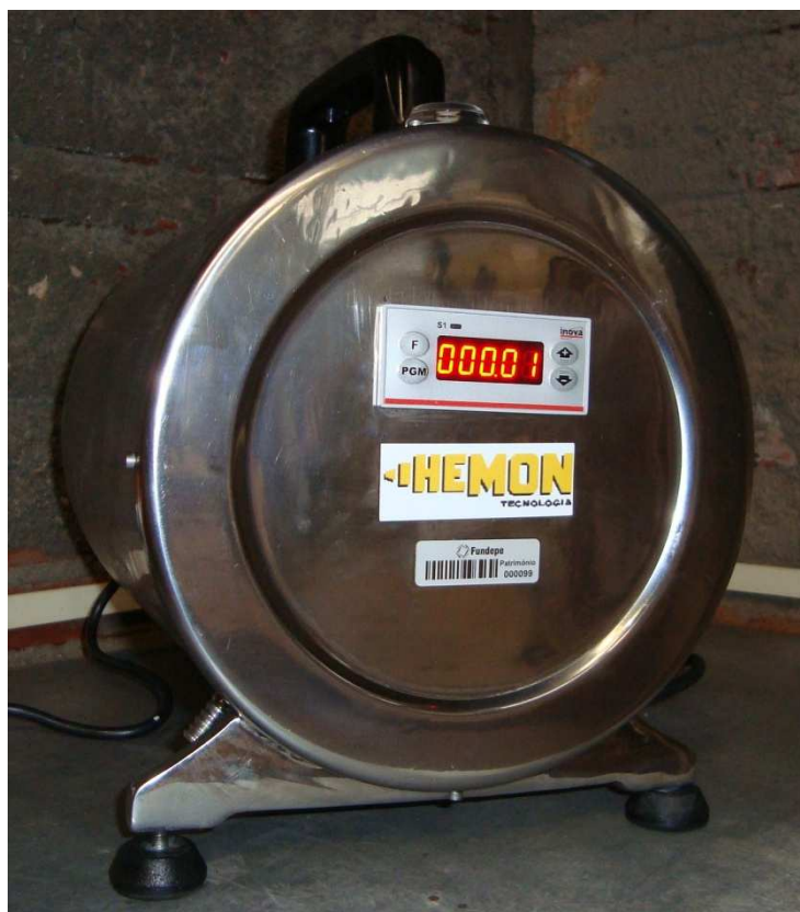
Figura 9: Medidor de vazão de biogás produzido
