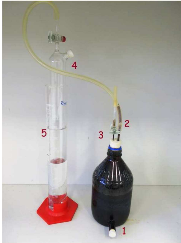
Figura 9 – Reator anaeróbio de bancada e sistema de medição de biogás
