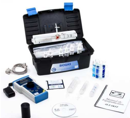
Figura 11 – Kit para análise de biogás Embrapa
