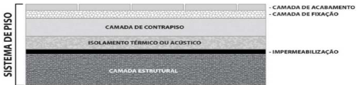
Figura 6 – Exemplo genérico de um sistema de pisos e seus elementos
