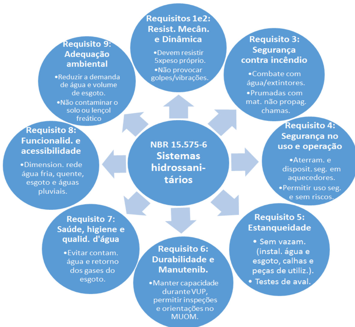
Figura 10 – Principais aspectos da NBR 15.575-6 - sistemas hidrossanitários
