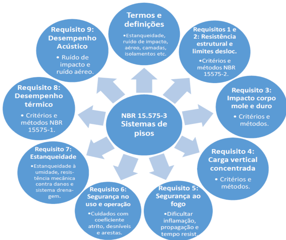
Figura 7 – Principais aspectos da NBR 15.575-3 - sistemas de pisos
