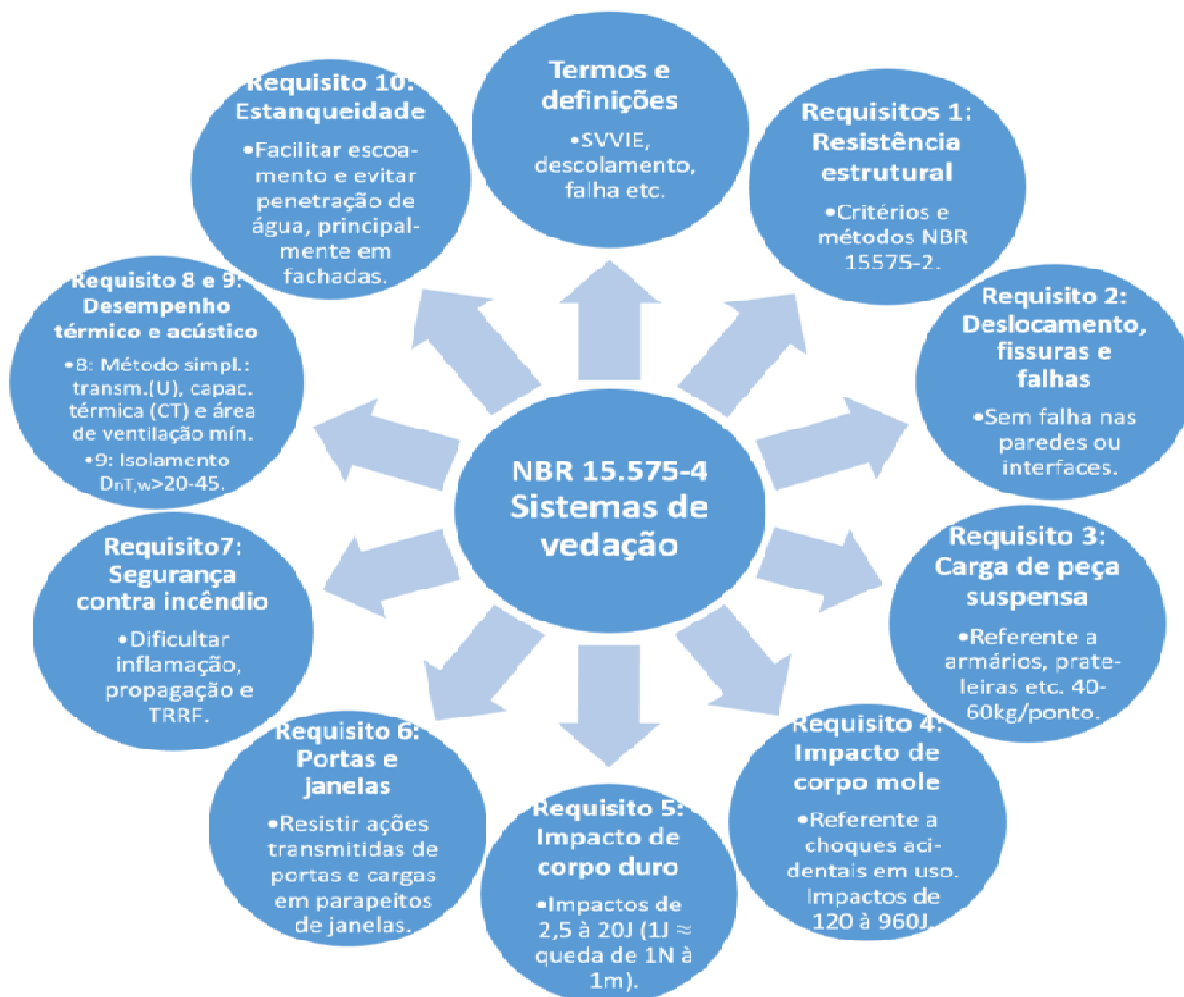
Figura 8 – Principais aspectos da NBR 15.575-4 - sistemas de vedação
