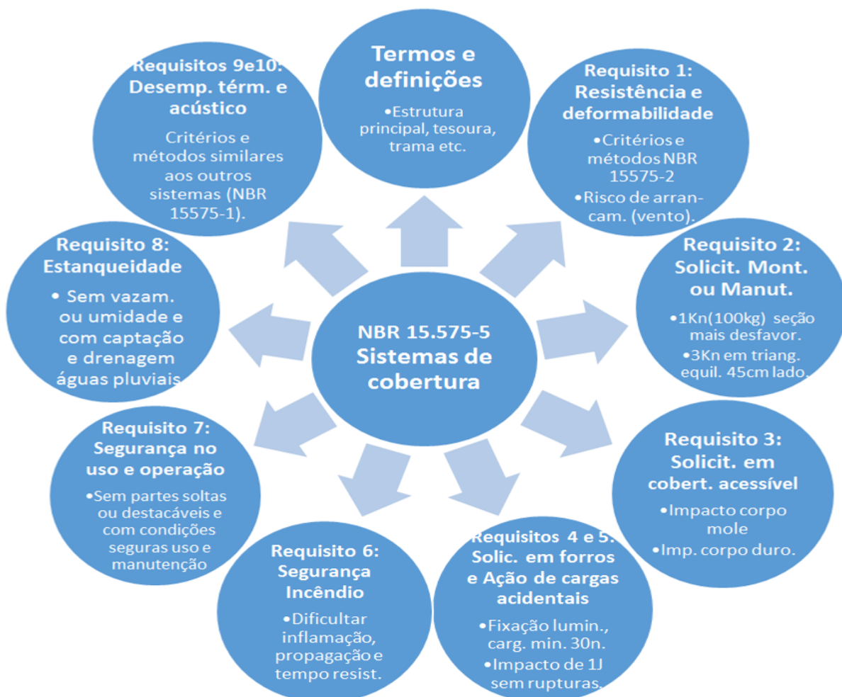
Figura 9 – Principais aspectos da NBR 15.575-5 - sistemas de cobertura
