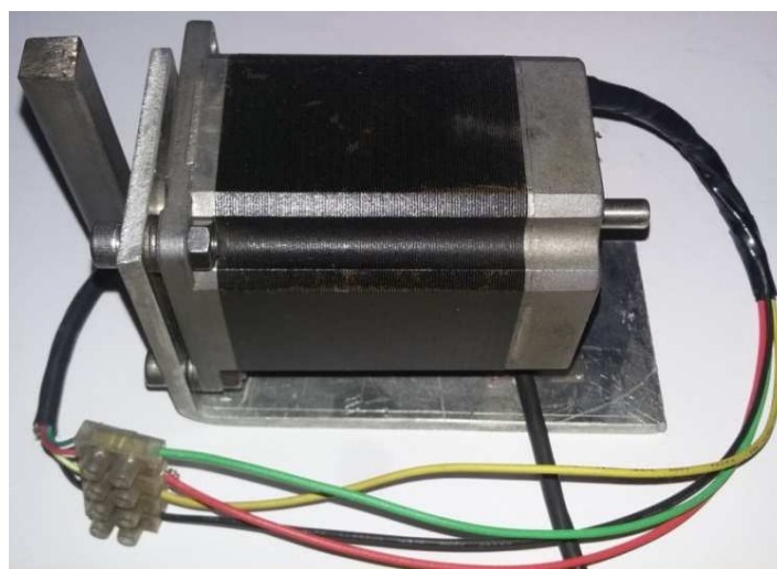
Figura 5.5 Imagem de um motor de 200 passos por revolução.
